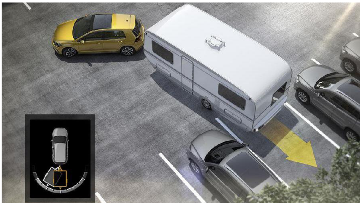
Obr. 3 Asistent pro couvání s přívěsem
