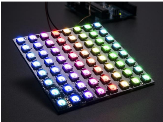
Obr. 29 RGB funkcionality LED modulu
