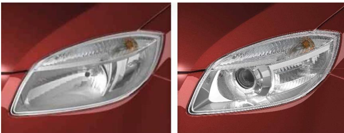
Obr. 13 Porovnání halogenového reflektorového a projektorového světlometu
