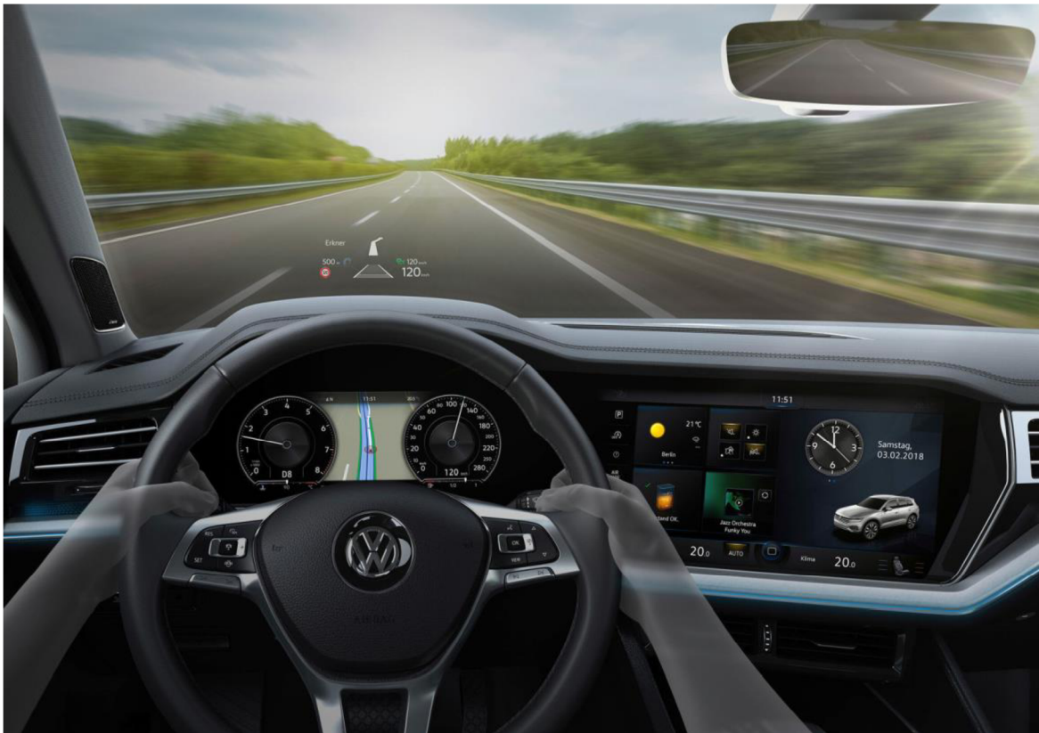
Obr. 2 Digitální kombinovaný přístroj
