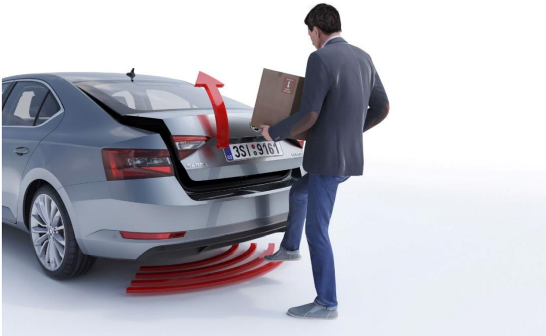
Obr. 5 Bezdotykové otevírání zavazadlového prostoru
