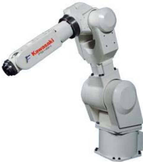
Obrázek 5-19 robot Kawasaki série F [9]
