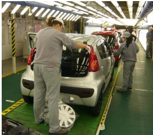
Obrázek 4-2 kontrola slícování zadní masky a boků
