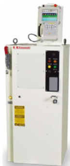
Obrázek 5-20 Kawasaki controller typ C [9]
