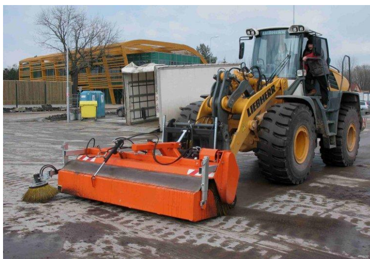
Obr. 30. Uložení zametače na rameni nakladače [25]
