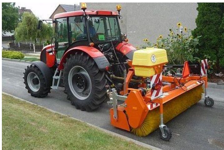
Obr. 29. Upevnění zametače do zadního třibodového závěsu traktoru [18]
