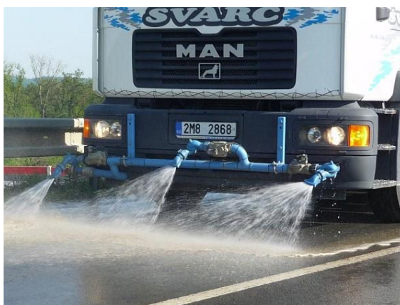
Obr. 17. Kropící vůz s připevněným potrubím na rámu automobilu [18]
