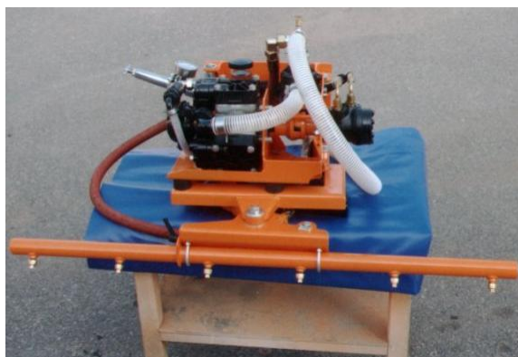
Obr. 19. Pevná mycí lišta poháněná samostatnou jednotkou [19]
