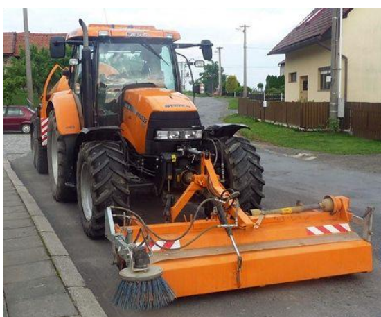
Obr. 28. Upevnění zametače do čelního třibodového závěsu traktoru [18]
