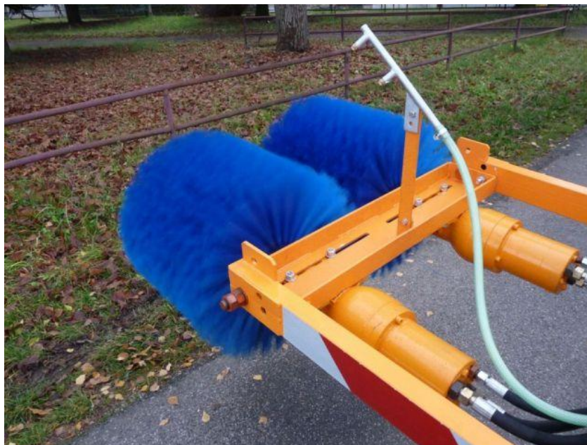
Obr. 6. Kartáče napojeny na hydraulický oběh vozu [5]
