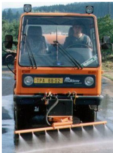
Obr. 18. Pevná mycí lišta poháněná čerpadlem na automobilu [19]
