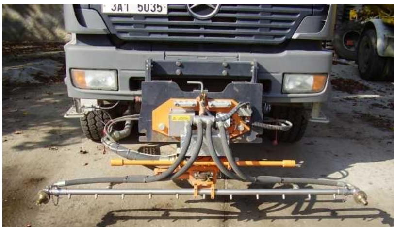
Obr. 21. Mycí lišta s proměnným natočením lišty MLS 3,4 [3]
