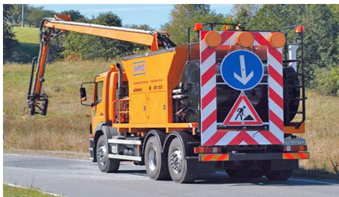
Obr. 2. Přenosná svislá značka připevňená na vozidle [14]
