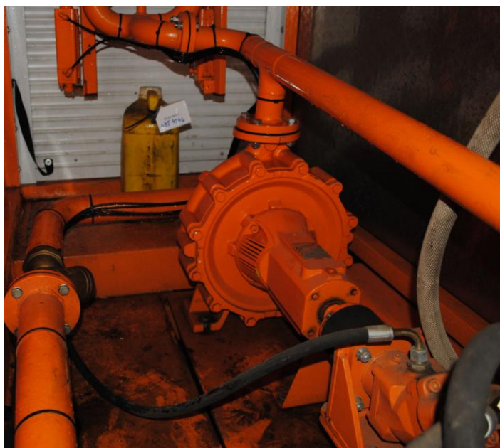
Obr. 16. Litinové spirální jednostupňové kozlíkové čerpadlo Sterling
