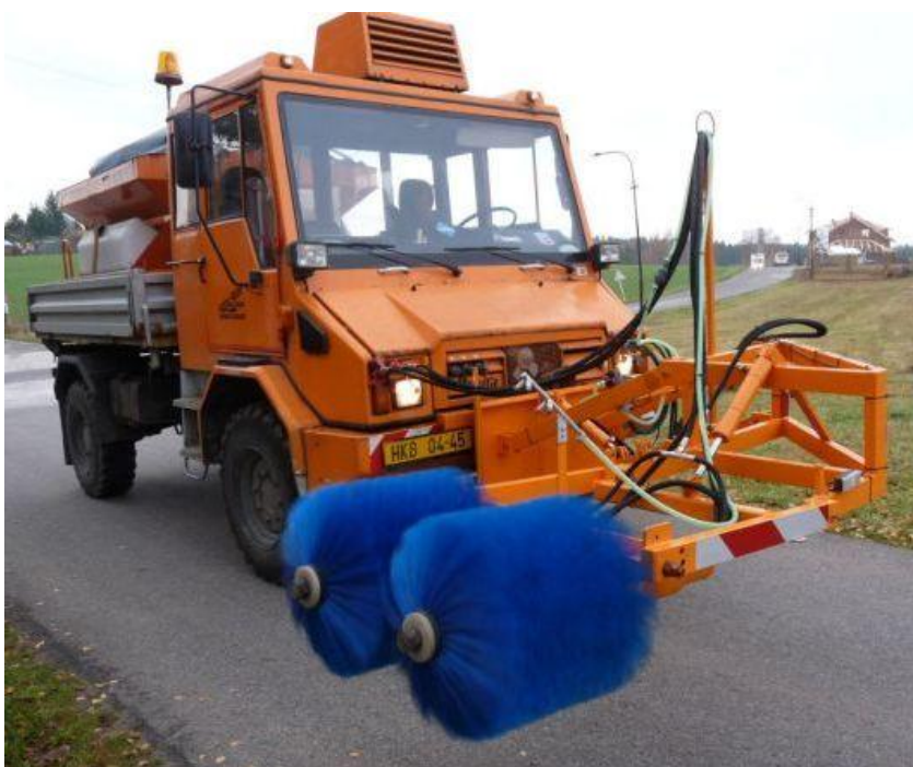
Obr. 7. Myčka sloupků umístěná na voze Mercedes Benz UNIMOG [5]
