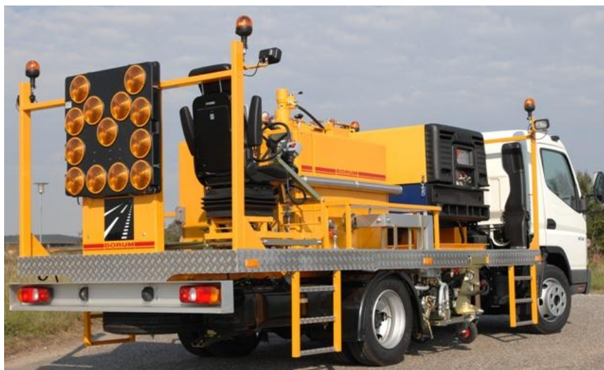
Obr. 14. Nákladní vůz se stříkací nástavbou [11]
