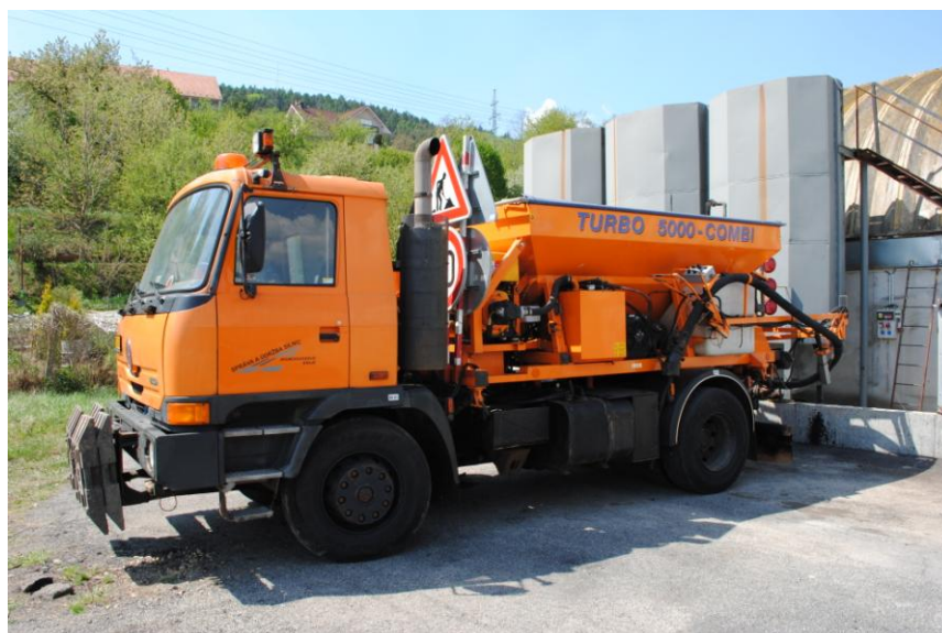
Obr. 33. Vysprávkový vůz se sypacím ramenem
