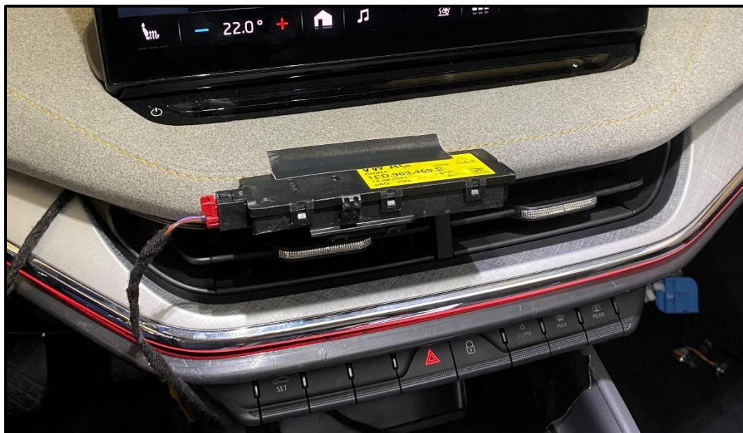
Obrázek 10: Experimentální umístění ionizátoru Paragon – pohled shora
