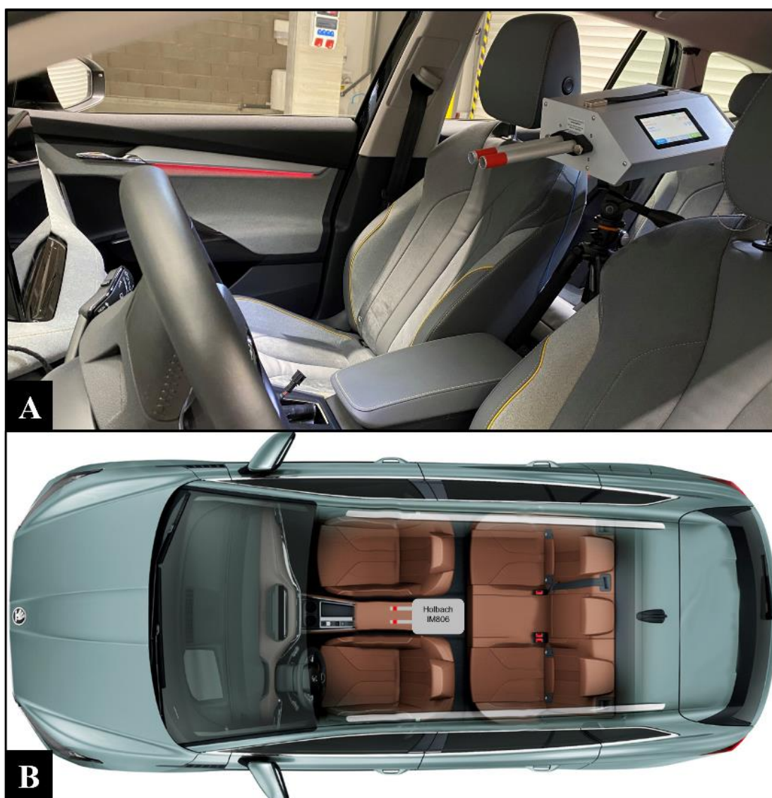
Obrázek 7: Pozice měřicího přístroje Holbach IM806V3 během jízdních zkoušek
