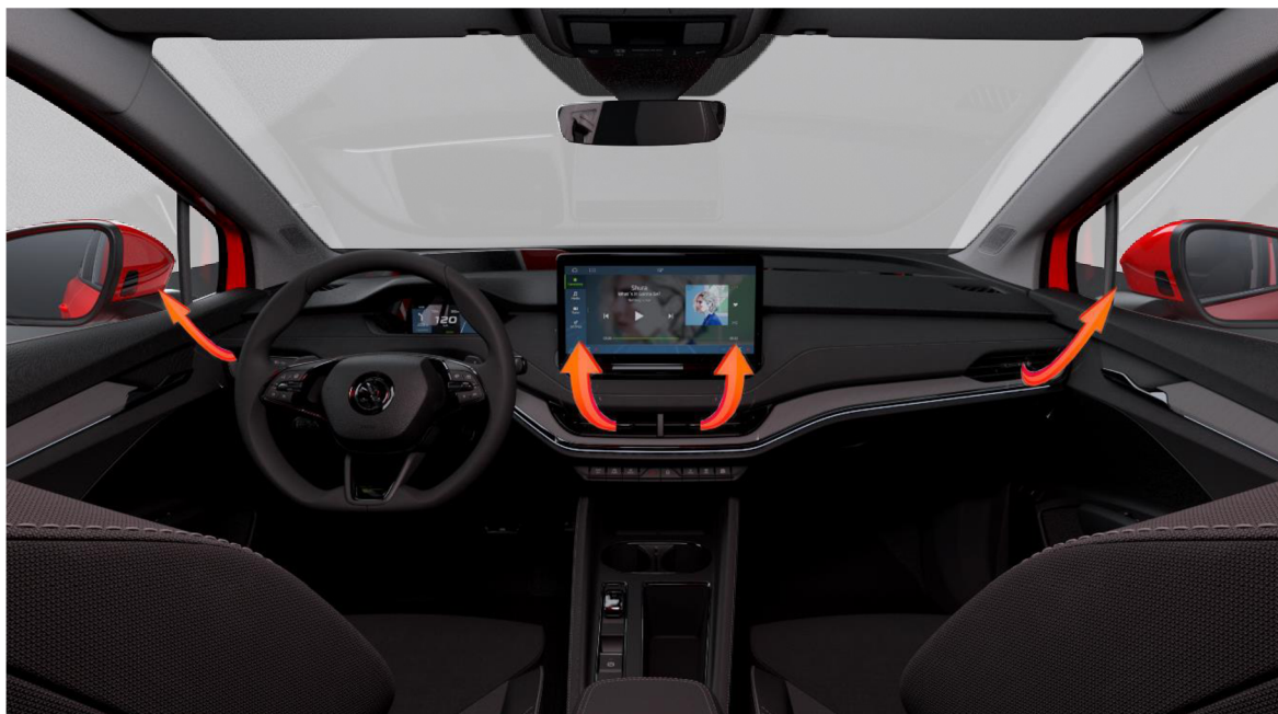
Obrázek 4: Nastavená poloha ofukovačů – Škoda Enyaq iV
