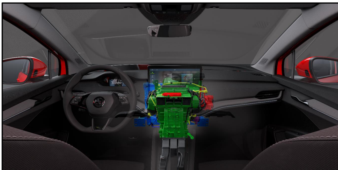
Obrázek 8: Poloha klimatizační skříňe s ionizátorem – Škoda Enyaq iV
