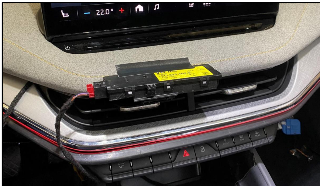
Obrázek 10: Experimentální umístění ionizátoru Paragon – pohled shora
