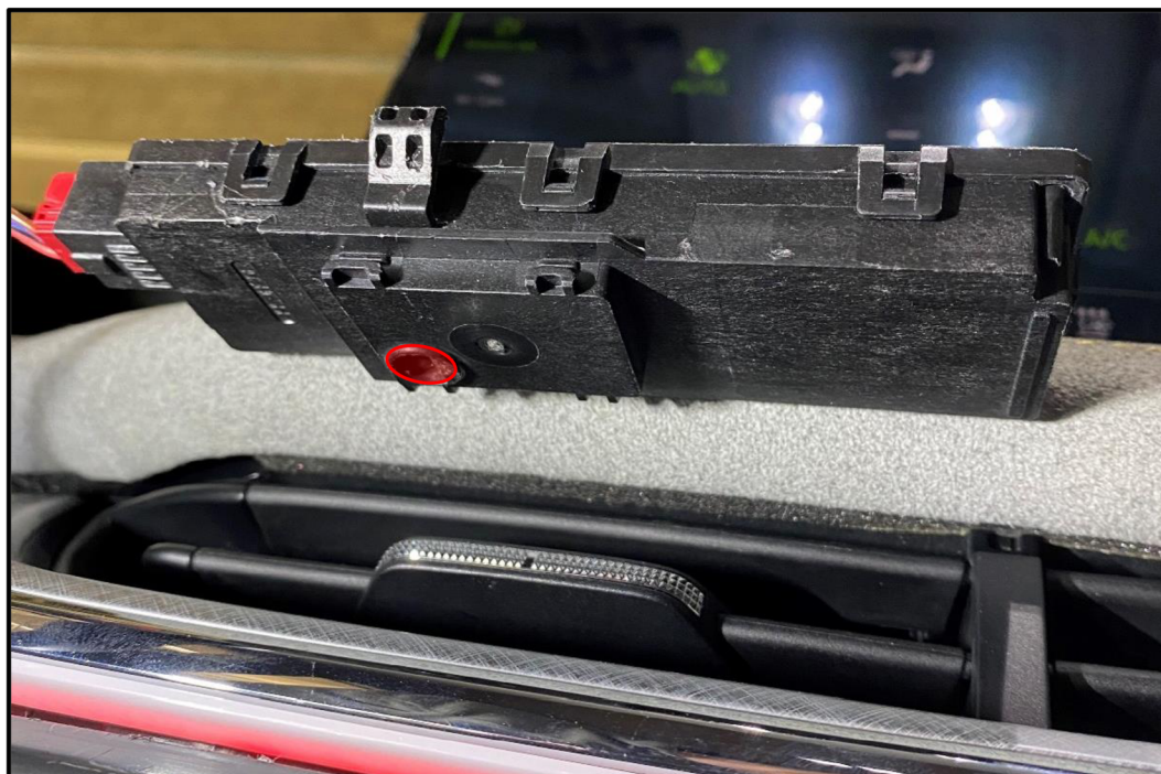
Obrázek 11: Experimentální umístění ionizátoru Paragon – pohled zdola
