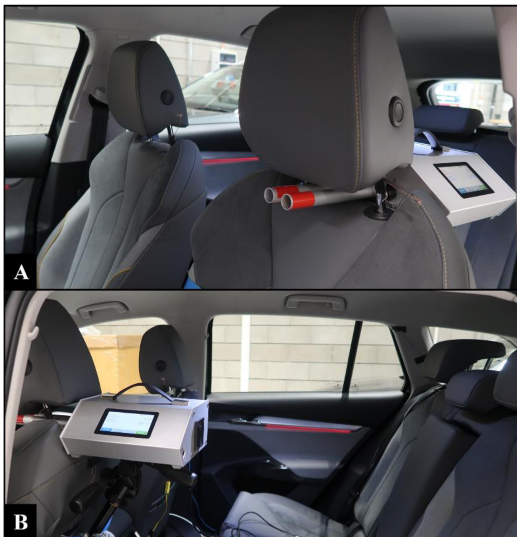
Obrázek 6: Pozice měřícího přístroje Holbach IM806V3 během stacionárních měření
