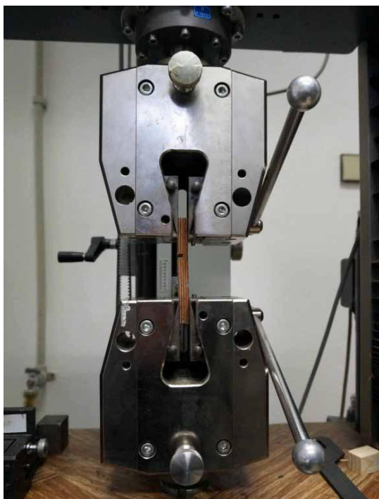
Obr. 6.3.2 – Uchycení vzorku v čelistech zkušebního stroje Zwick Z050 s horním pohybem příčnicku. (Zdroj: vlastní)
