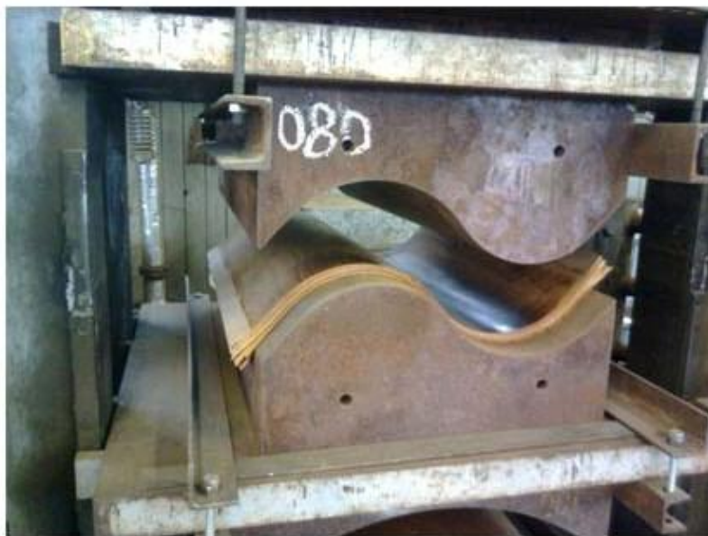
Obr. 4.8.1 – Lisování tvarované překližky v TON a.s. Holešov. (Zdroj:vlastní)
