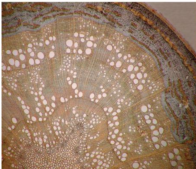
Obrázek 13 a 14: Detail kruhovitě pórovitého dřeva dubu letního (vlevo) a detail roztroušeně pórovitého dřeva lípy srdčité (vpravo).
