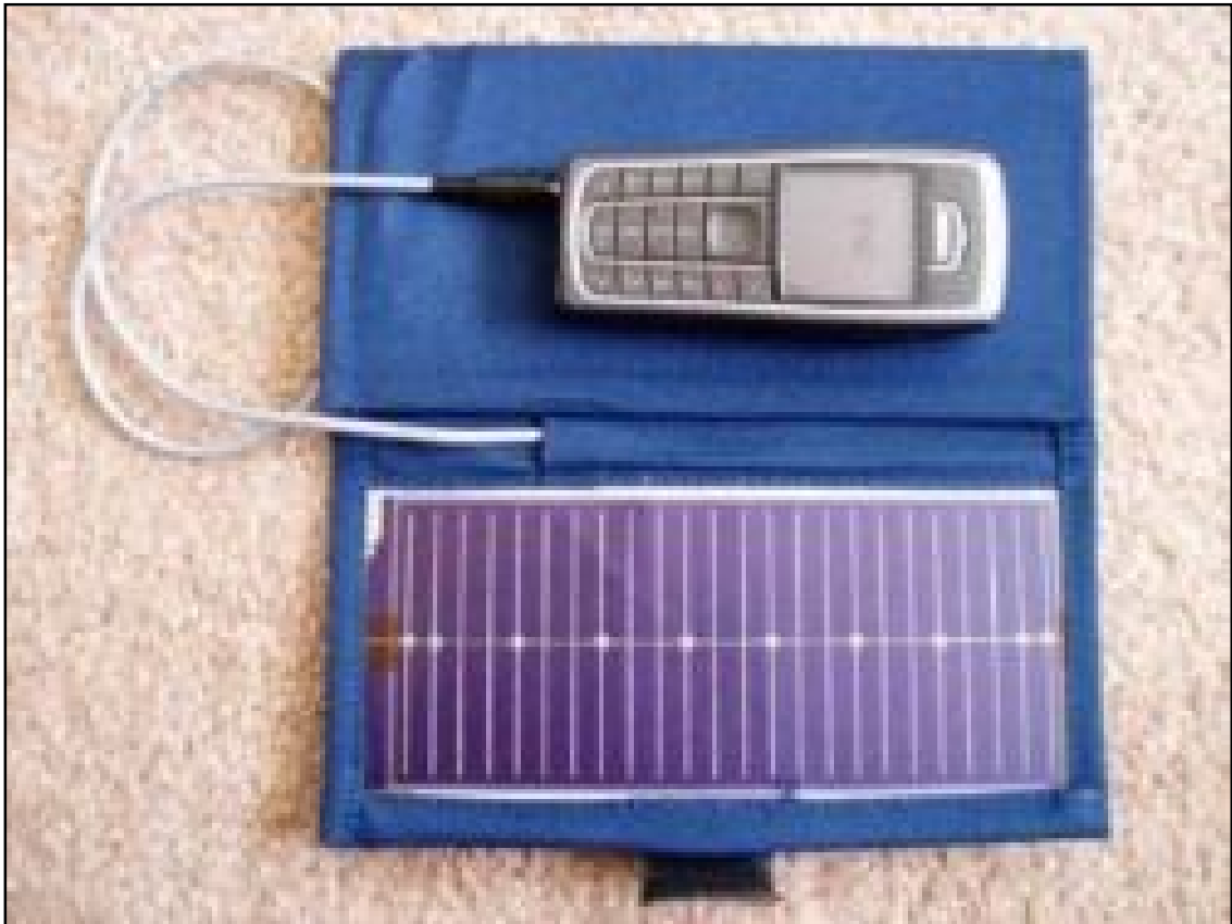
Obrázek č. 27: Drobné solární zařízení pro okamžité dobíjení akumulátorů, zdroj: http://www.czrea.org/cs/druhy-oze/fotovoltaika (2012)
