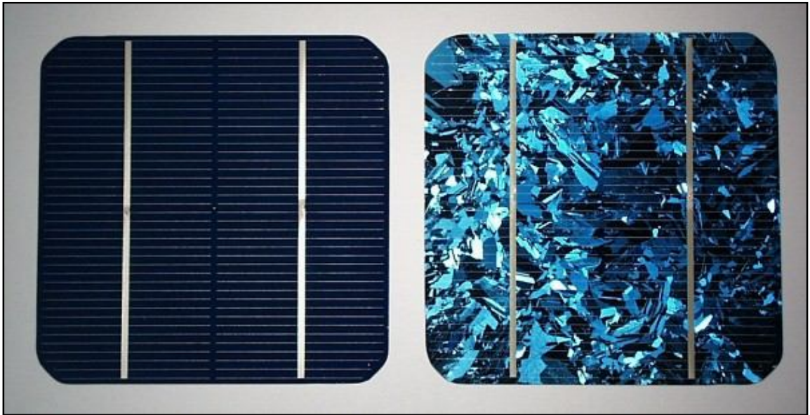
Obrázek č. 19: Fotovoltaické články z monokrystalického a polykrystalického křemíku, zdroj: http://www.tzb-info.cz/5073-problemy-fotovoltaickych-projektu-z-hlediska-energetickeho-auditu (2008)
