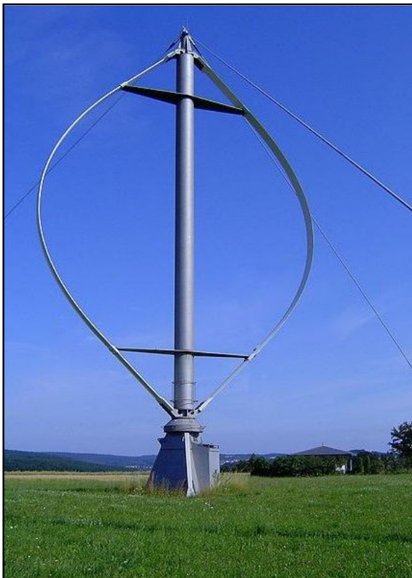
Obrázek č. 32: Darrierův rotor, zdroj: http://www.brighthub.com/environment/renewable-energy/articles/92978.aspx (2011)
