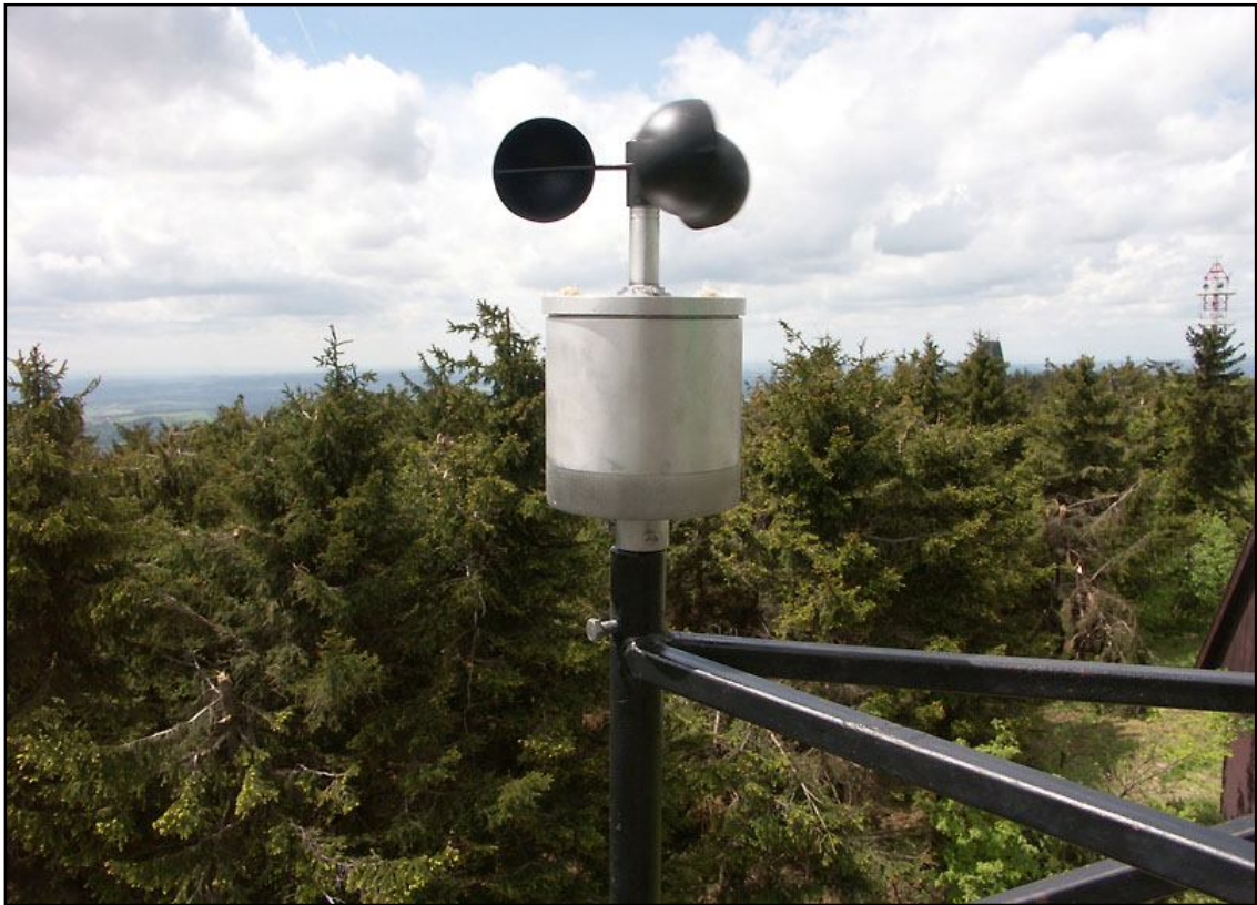
Obrázek č. 29: Miskový anemometr, zdroj: http://www.cbfaltus.cz/fotky.php?albumNr=8 (2006)
