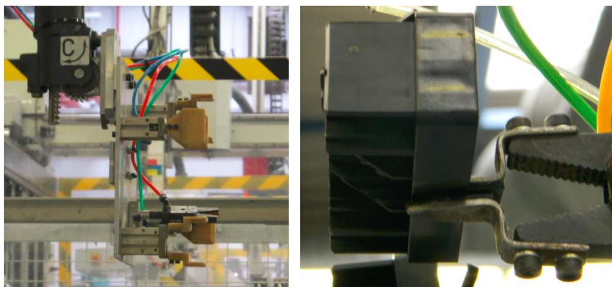
Obr. 3.2 Uchopovač při vyjímání výlisku z formy
