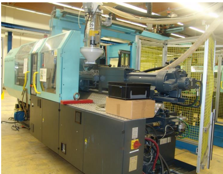
Obr. 3.1 Vstřikovací stroj Demag IntElect [17]
