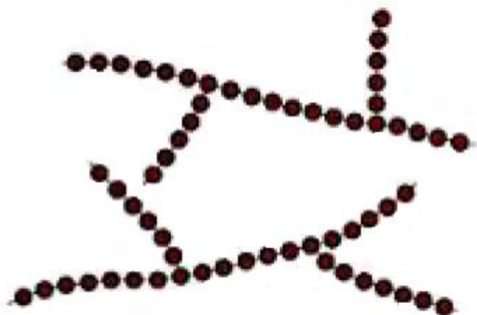
Obr. 1.2 Rozvětvené uspořádání polymeru [8]
