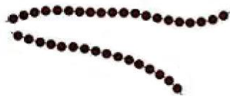
Obr. 1.1 Lineární uspořádání polymeru [8]
