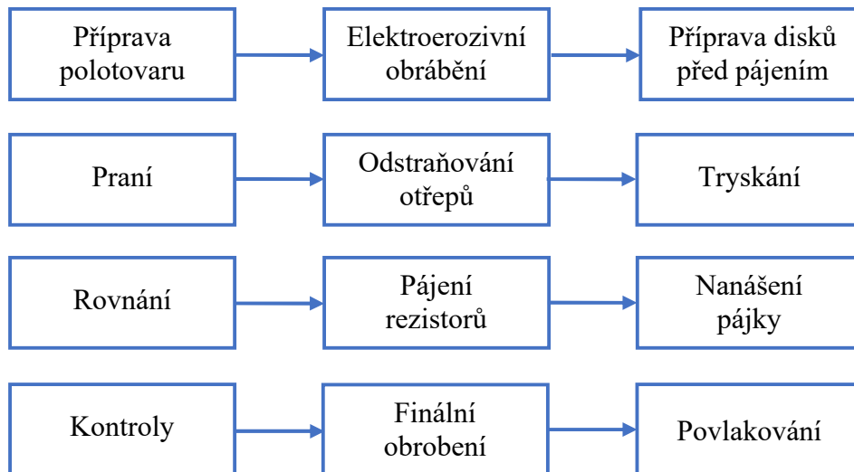
Obr. 5 Schéma postupu operací při výrobě EDM atmosférického rezistoru.
