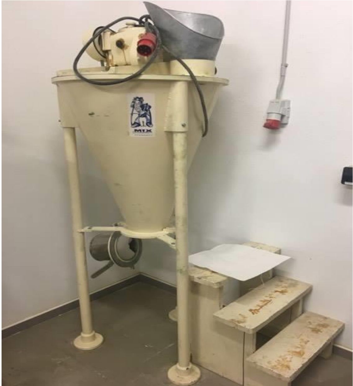
Obrázek č. 25: Přístroj pro míchání krmné směsi
