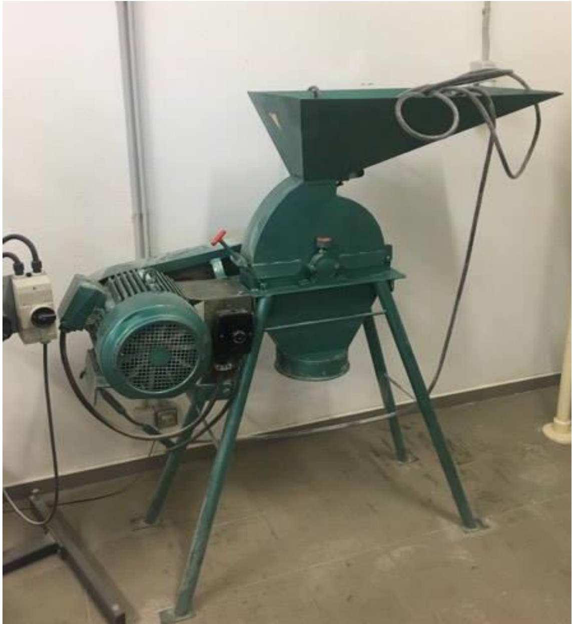
Obrázek č. 24: Přístroj pro šrotování komponentů krmné směsi
