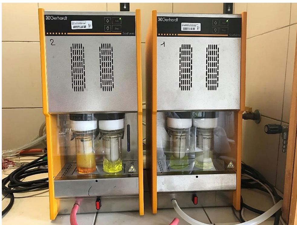
Obr. 12: Príprava hexánových extraktov pomocou prístroja Soxtherm (zľava: zázvor, harmanček, mäta, ľan)
