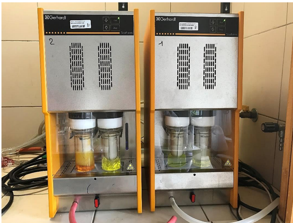
Obr. 12: Príprava hexánových extraktov pomocou prístroja Soxtherm (zlava: zázvor, harmanček, mäta, ľan)
