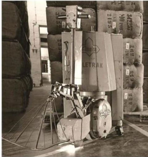
Obrázek 2: AGV vozík “Teletrak” od společnosti Jungheinrich , optické vedení. [1]
