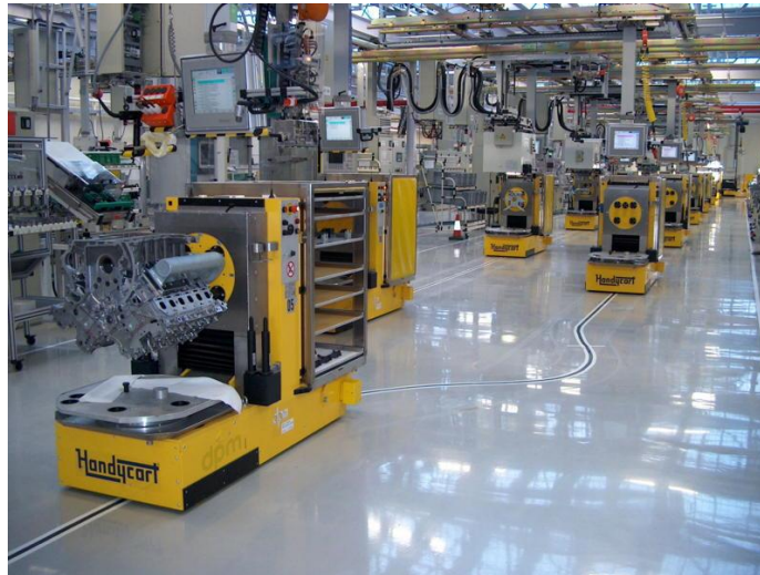
Obrázek 10: Optické navádění AGV. [3]
