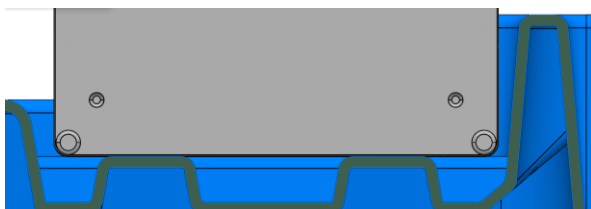
Obrázek 64: Vyztužení dna šasi profilováním s umístěním baterie.
