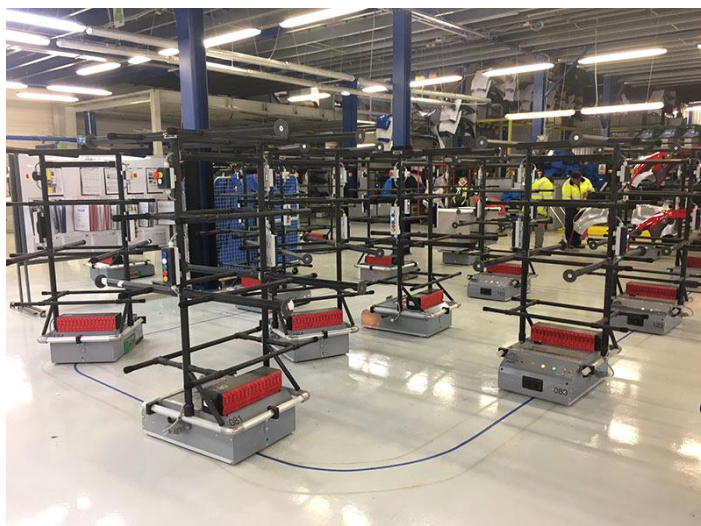
Obrázek 47: Zkušební provoz AGV na stanovištích montáže v závodě Magna Nymburk. [18]
