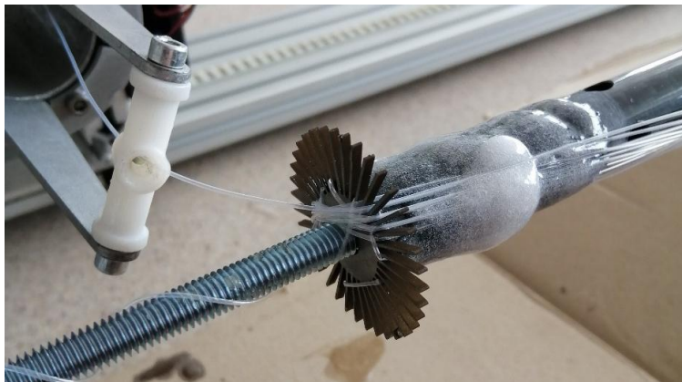
Obr. 24 Navíjení vložky výměníku v okrajové části s naneseným lepidlem
