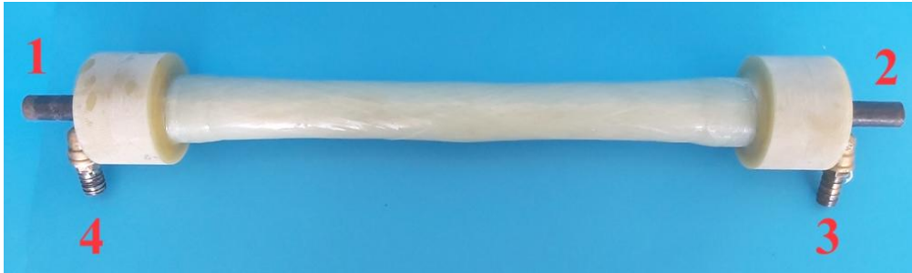
Obr. 33 Hotový chladič s oběma vstupy i výstupy 1) vstup do pláště 2) výstup z pláště 3) vstup do vláken 4) výstup z vláken
