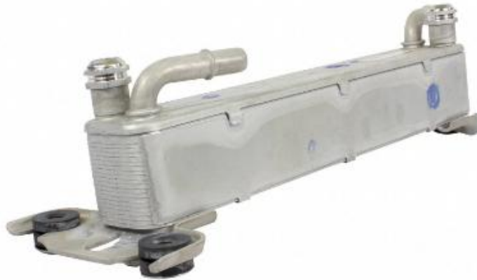
Obr. 19 Deskový chladič převodového oleje vozidla Ford F-150 [58]
