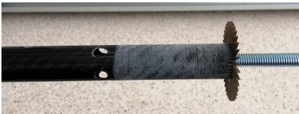
Obr. 22 Karbonová trubka s připravenými otvory a zdrsňeným koncem
