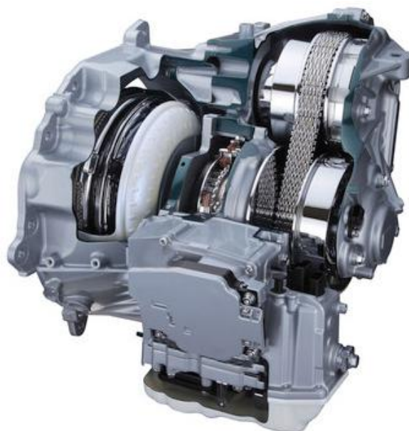
Obr. 4 Převodovka s plynulou změnou převodu Jetco CVT-X [8]
