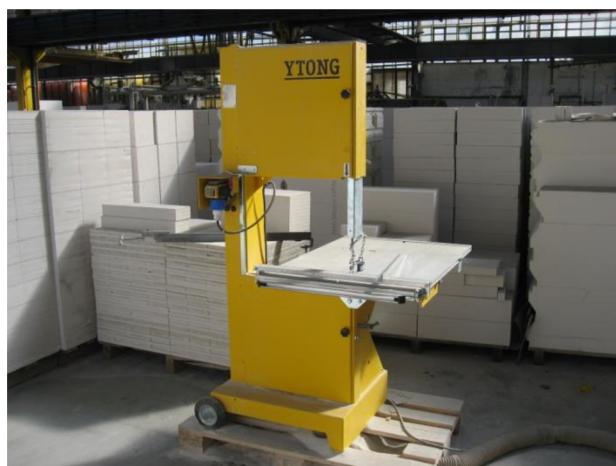
Obrázek 16 Pásová pila pro přípravu zkušebních těles
