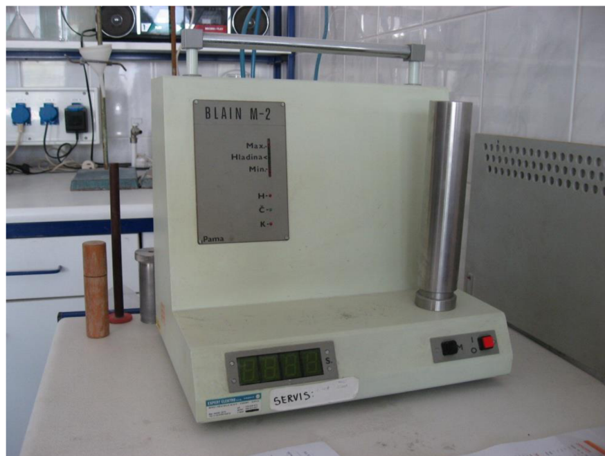
Obrázek 5 Přístroj BLAIN M-2
