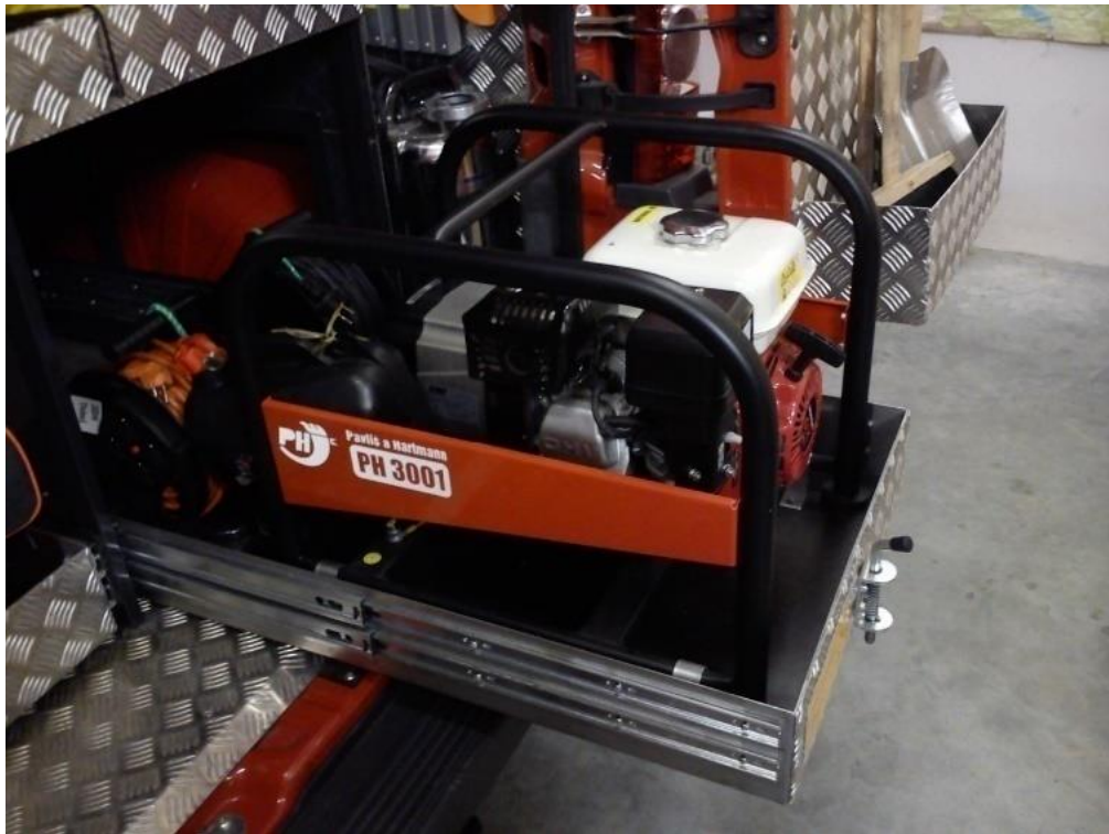
Obrázek 16 Elektrocentrála PH 3001 Zdroj: https://jsdhtrebes.webnode.cz/vybaveni/
