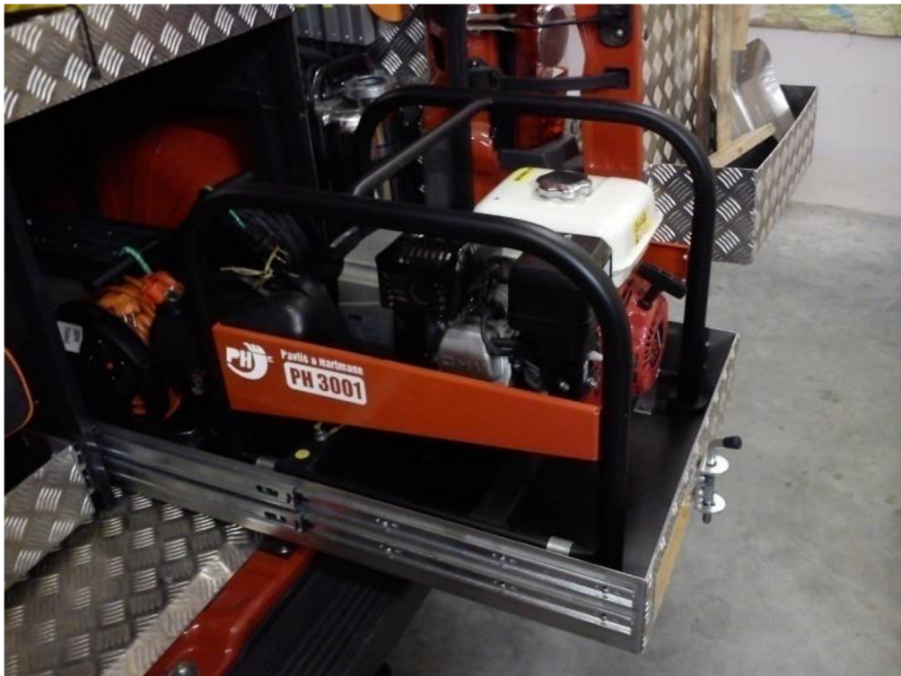
Obrázek 16 Elektrocentrála PH 3001 Zdroj: https://jsdhtrebes.webnode.cz/vybaveni/
