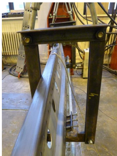
Obr. 6.12 Kontakt zlušebního tělesa s rámem táhla
