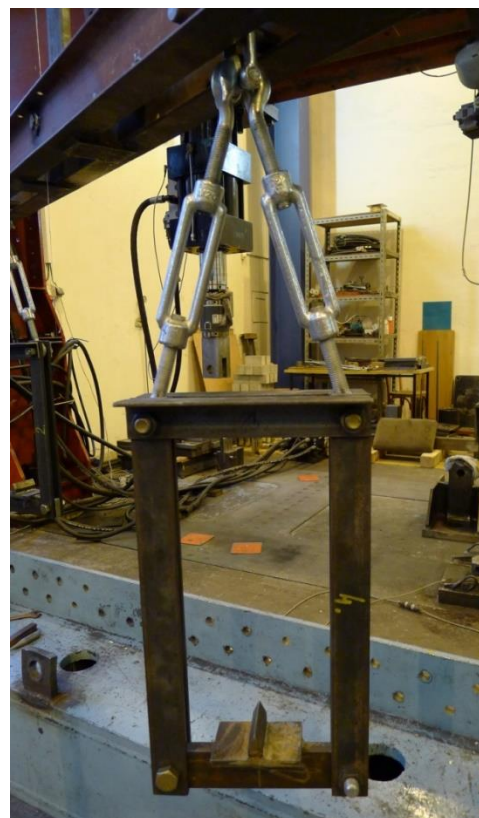
Obr. 6.9 Realizace zatěžovacího táhla
