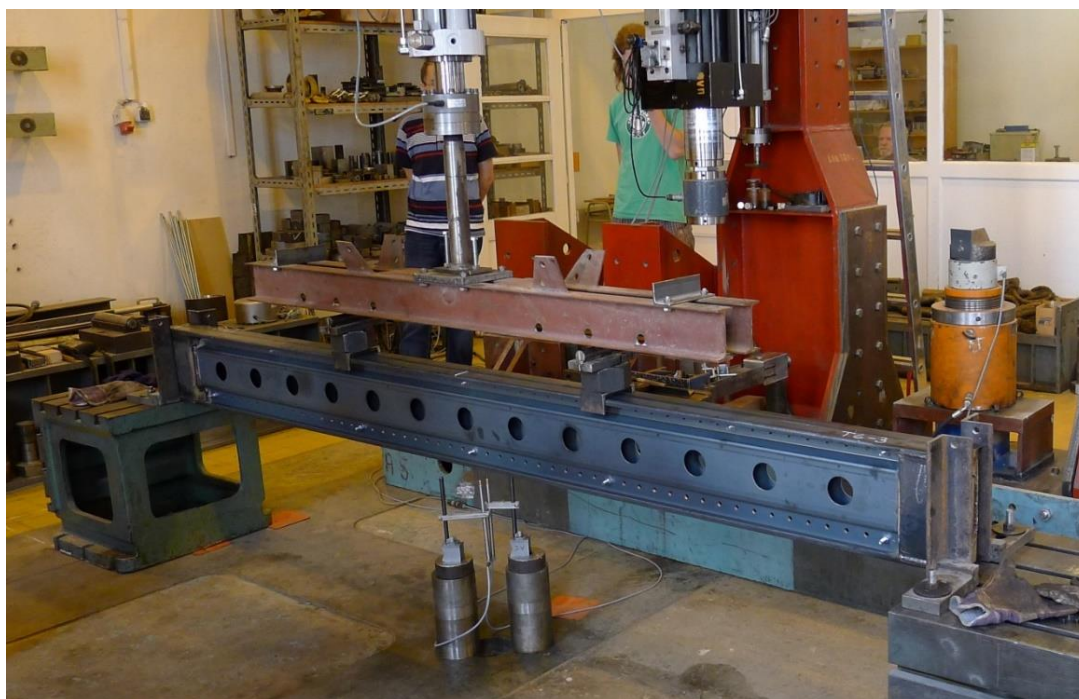
Obr. 6.6 Schéma zkušební sestavy s roznosem síly do třetin rozpětí
