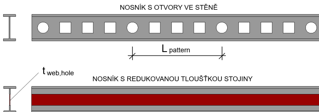
Obr. 7.1 Schéma k výpočtu redukované tloušťky stojiny
