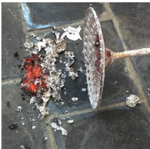
Obr. 39 Stěr z hladiny před odběrem vzorku 104
