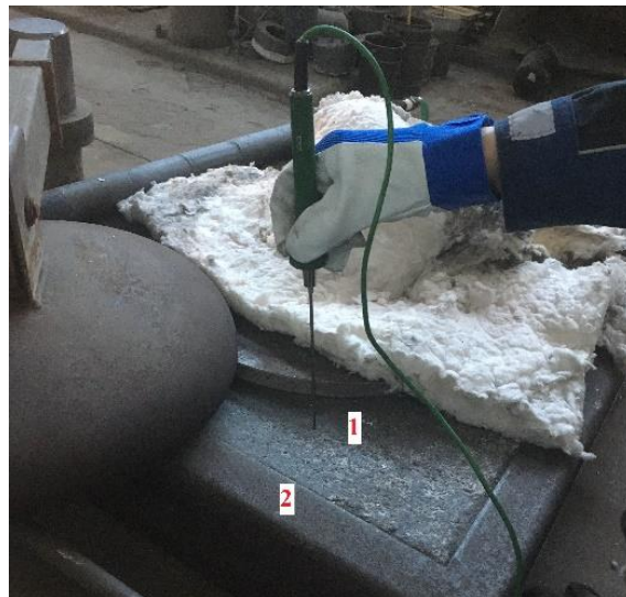
Obr. 53 Měření teploty víka pece
