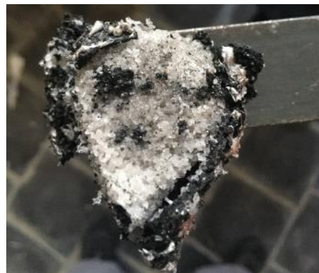
Obr. 42 Naplyňovací tableta obsažená ve stěru – po přehřevu
