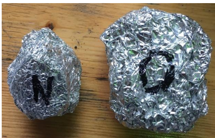
Obr. 37 Označené a navážené tablety zabalené do hliníkové fólie: N – naplyňovací, O – odplyňovací
