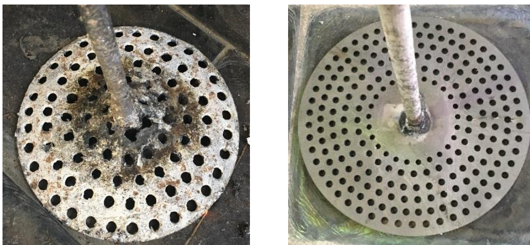
Obr. 48 Ponorný zvon: dosud používaný (vlevo) a nově zhotovený (vpravo)
