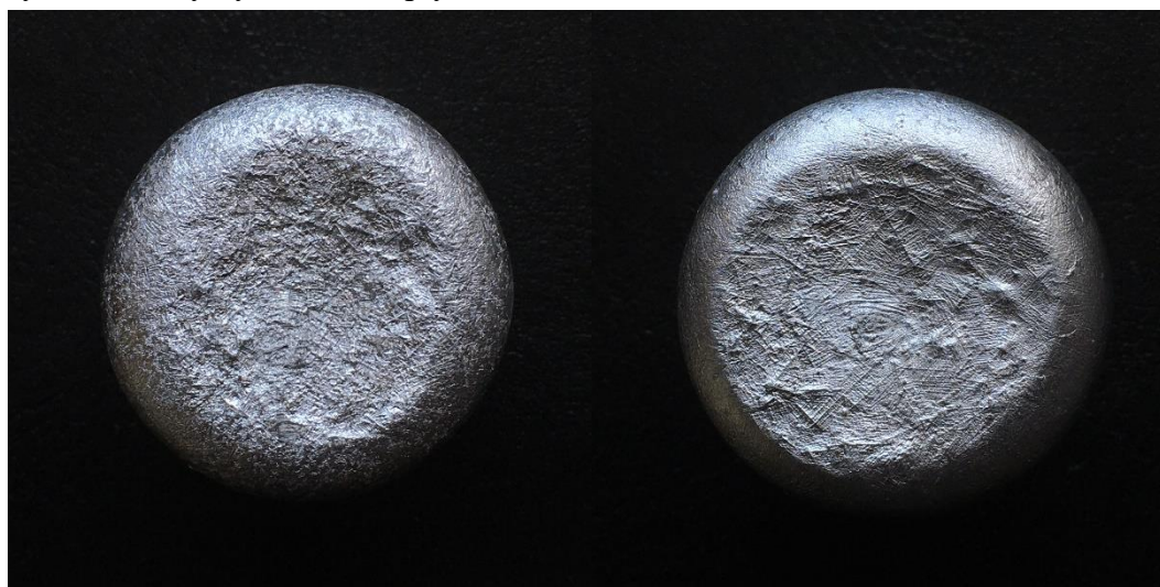
Obr. 56 Pohled shora na vzorky ztuhnuté za atmosférického tlaku: 5Ø (vlevo) a 5Ar4 (vpravo)
