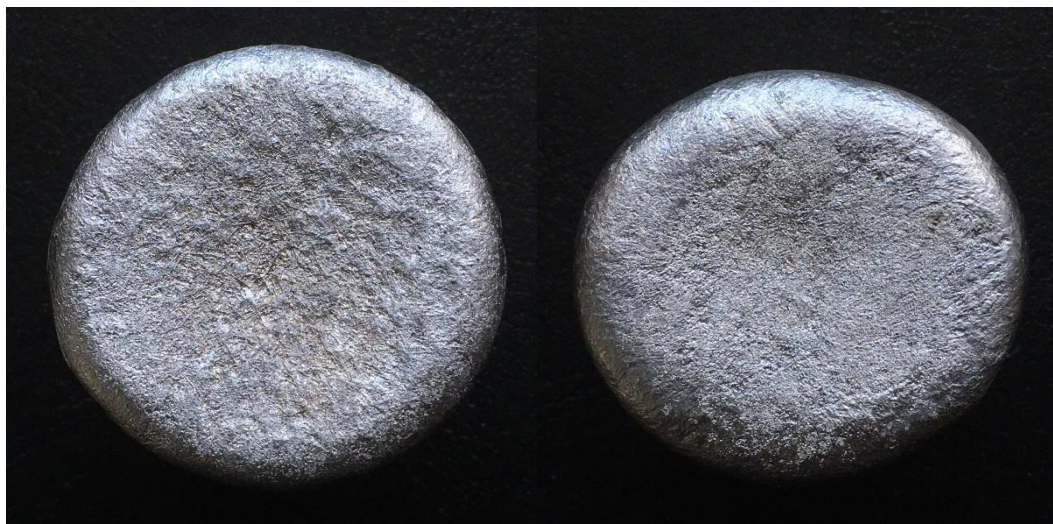
Obr. 55 Pohled shora na vzorky ztuhnuté za atmosférického tlaku: 1Ø (vlevo) a 1O4 (vpravo)
