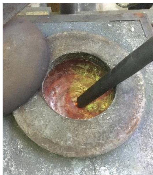
Obr. 44 Probublávání přes porézní zátku: Princip [62] (vlevo) a průběh metody (vpravo)
