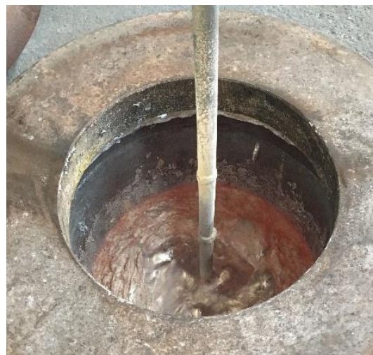
Obr. 40 Vyplouvání bublin středem zvonu
