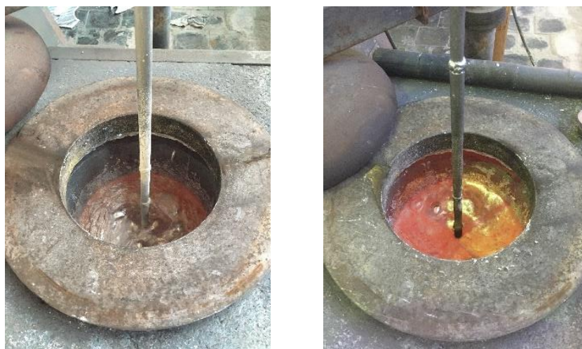
Obr. 51 Vyplouvání bublin: původním zvonem (vlevo) a novým zvonem (vpravo)
