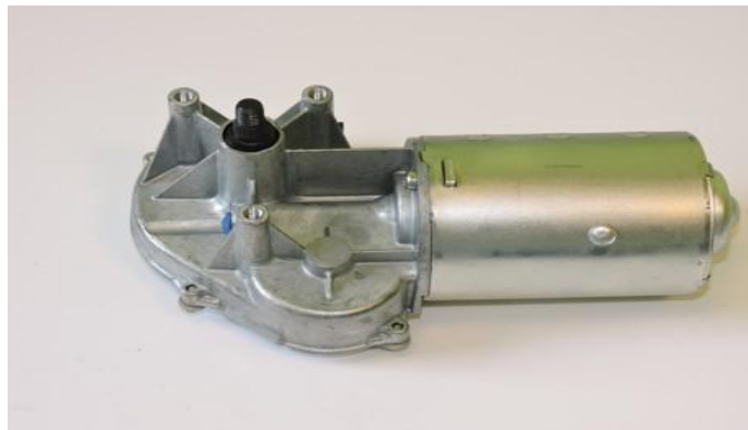
Obr. 27 Motorek předních stěračů [23]
