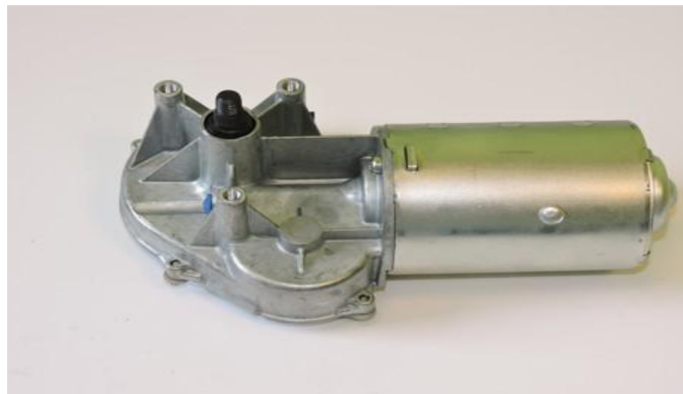
Obr. 27 Motorek předních stěračů [23]
