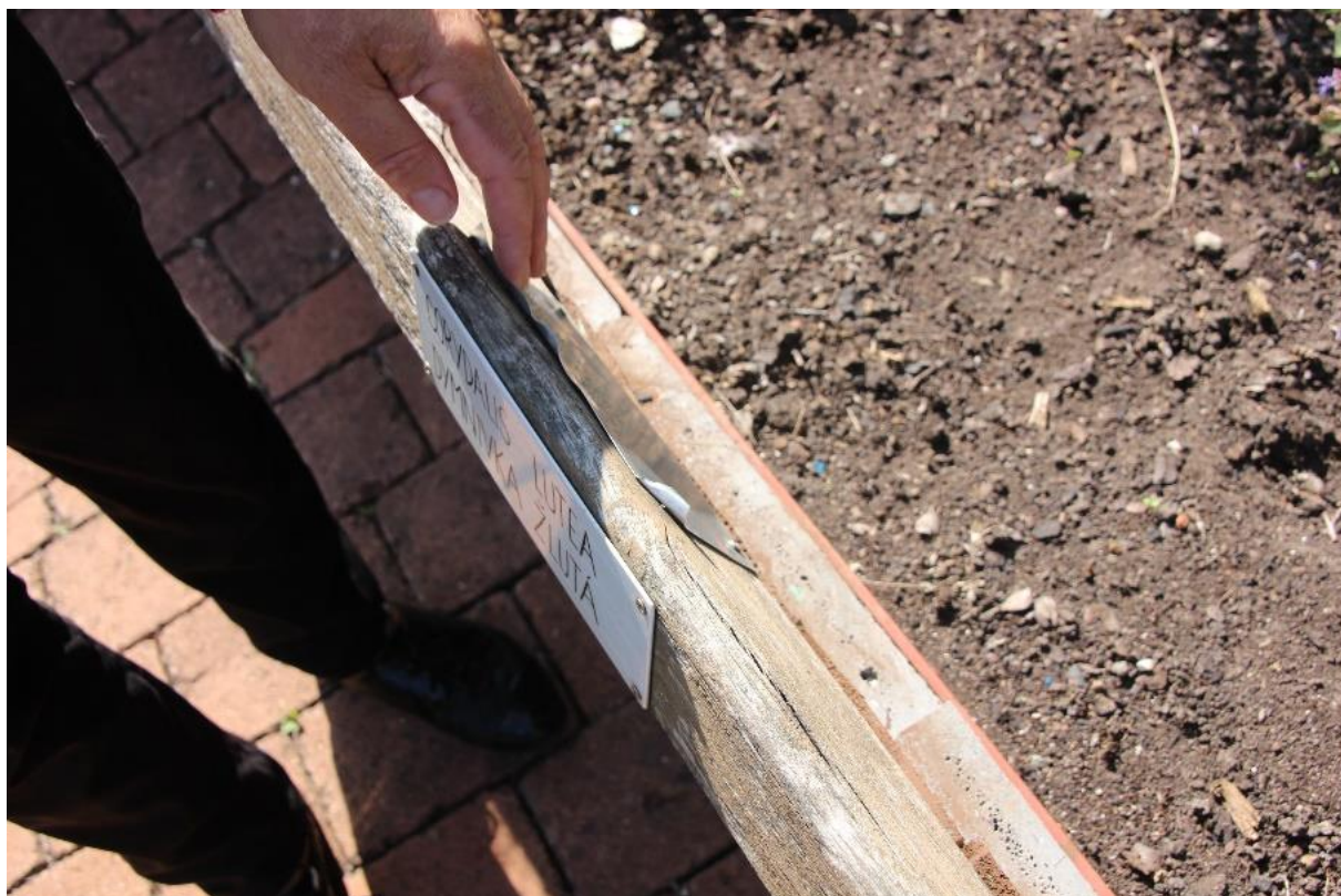
Obrázek 15: Poškozený hliníkový štítek
