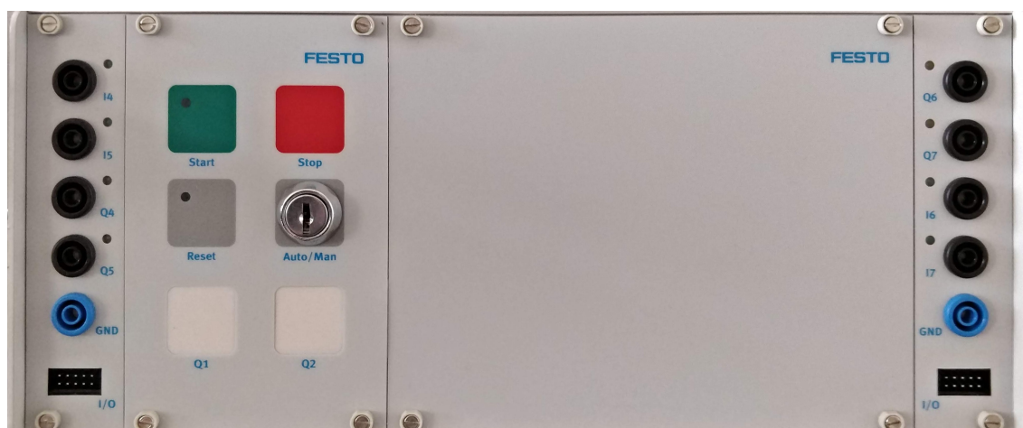
Obrázek 2.2: Řídicí panel s digitálními vstupy a výstupy
