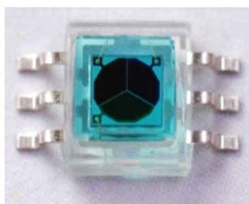
Obr. 2.13: Snímač S9032-02 a jeho citlivost na barvy ve spektru světla[10]
