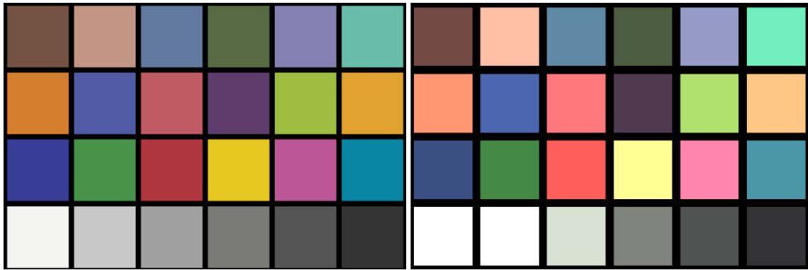
Obr. 5.1: ColorChecker, nalevo - originální barvy, napravo - naměřené barvy
