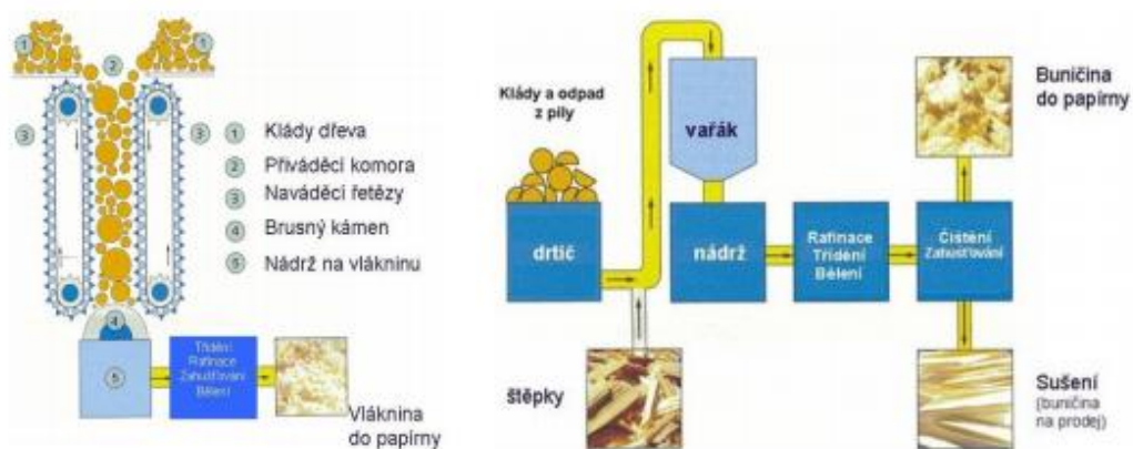
Obrázek č.5: Mechanická výroby vlákniny a výroba termo-mechanické vlákniny (Atlantis 2013)
