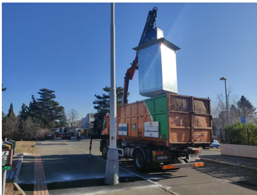
Obrázek č.14: Výsyp podzemního kontejneru na papír (Autor 2022)
