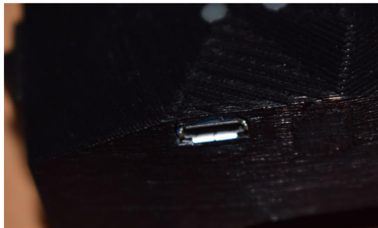
Obrázok 4.15 Qduino Mini nové umiestnenie USB konektoru
