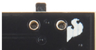
Obrázok 4.11 Qduino Mini pôvodný vypínač
