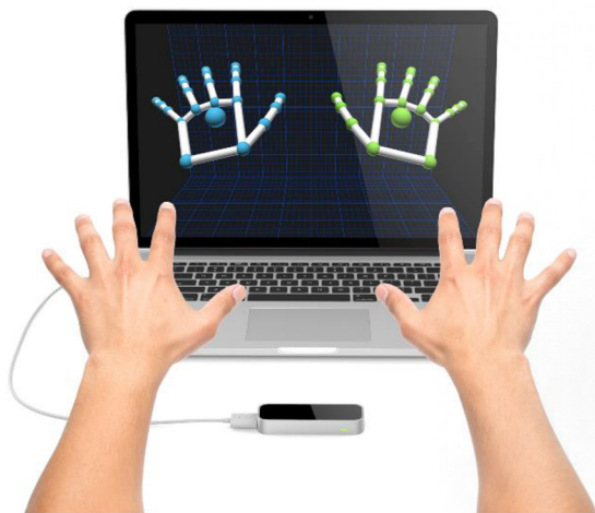
Obrázok 2.4 Zariadenie Leap Motion, ukážka funkčnosti
