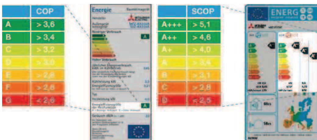
Obr. 23 Porovnání původních hodnot a tříd pro režim topení (COP a SCOP)
