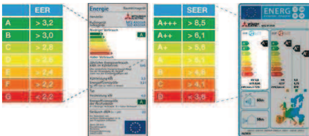
Obr. 22 Porovnání původních hodnot a tříd pro režim chlazení (EER a SEER)
