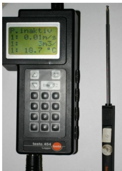
Obr. 7. 1: Multifunkční přístroj a žhavená kuličková sonda TESTO.
