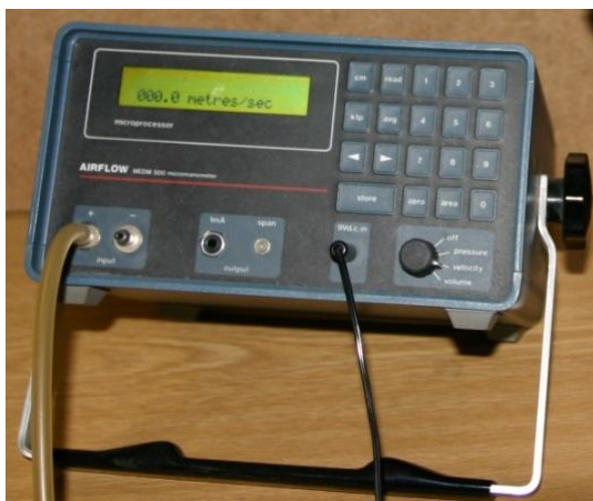
Obr. 6. 2: Digitální mikromanometr MEDM 500 firmy AIRFLOW.
