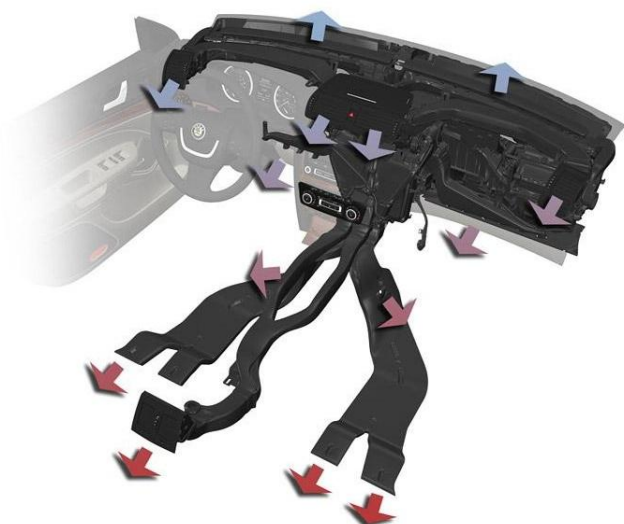
Obr. 4. 1: Uspořádání ofukovačů ve voze.[2]
