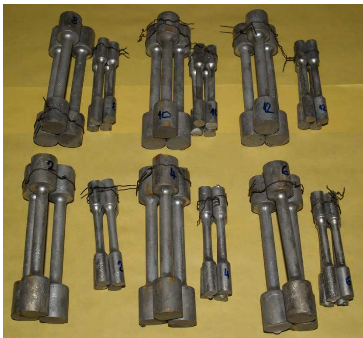
Obr. 7.1 Rozdělení zkušebních tyčí do skupin pro umělé stárnutí
