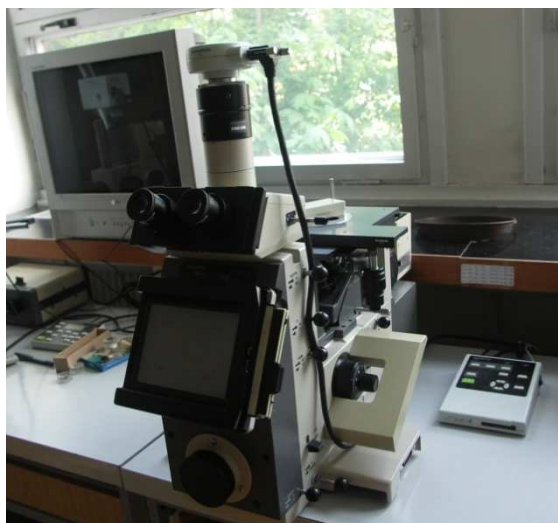
Obr. 8.4 Metalografický mikroskop Olympus PMG 3 s digitální kamerou Olympus DP20
