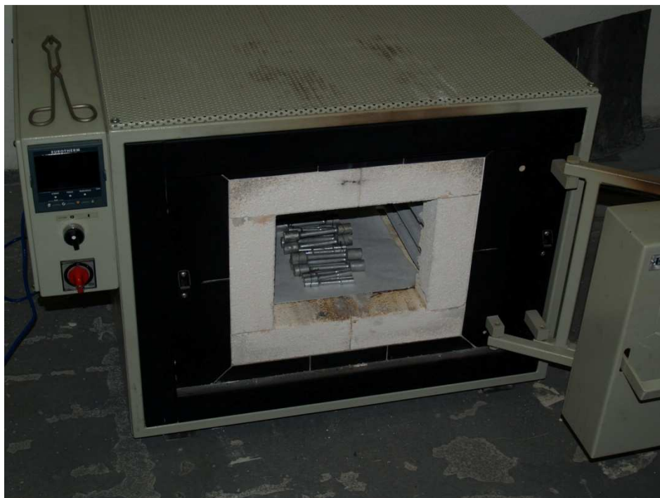
Obr. 7.2 Vzorky založené do pece pro umělé stárnutí
