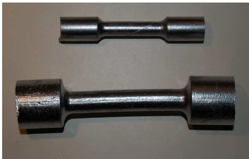
Obr 6.1 Zkušební válcové tyče o \varnothing 6 mm a \varnothing 9 mm
