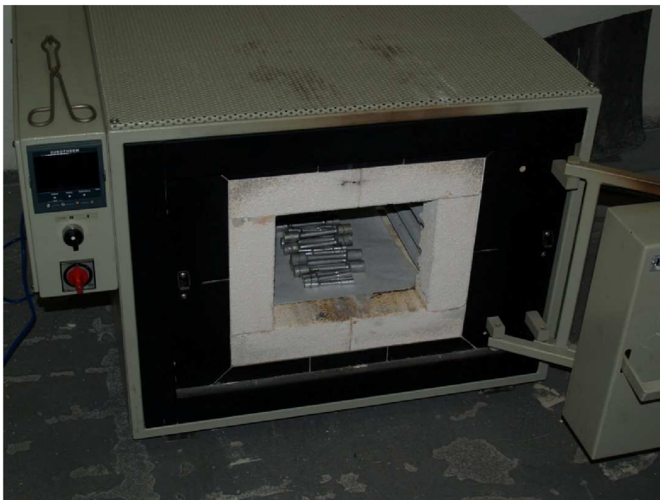
Obr. 7.2 Vzorky založené do pece pro umělé stárnutí
