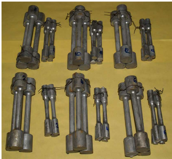
Obr. 7.1 Rozdělení zkušebních tyčí do skupin pro umělé stárnutí
