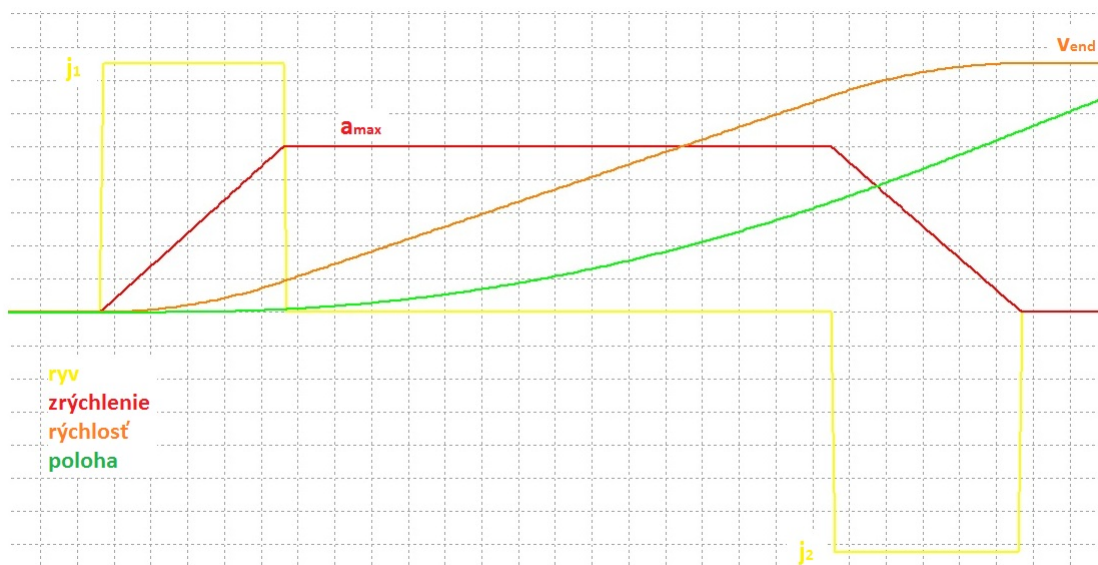
Obrázek 6.2: Graf priebehu zrýchľovania s dosiahnutím maximálneho zrýchlenia
