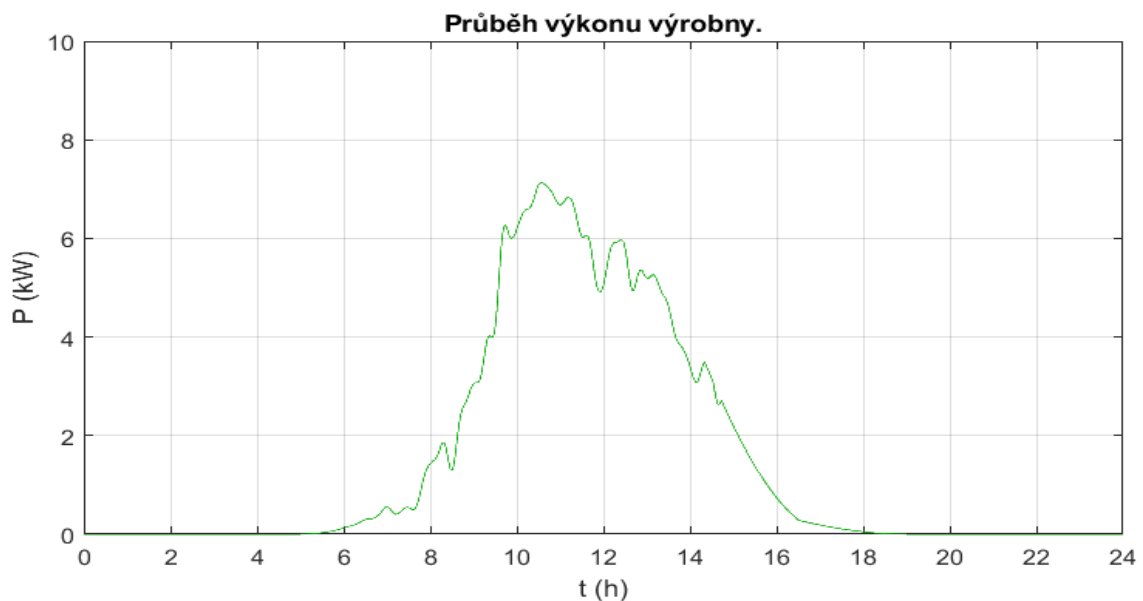
Obrázek 22: Příklad průběhu výkonu výroby, P_i = 10 \text{ kWp}
