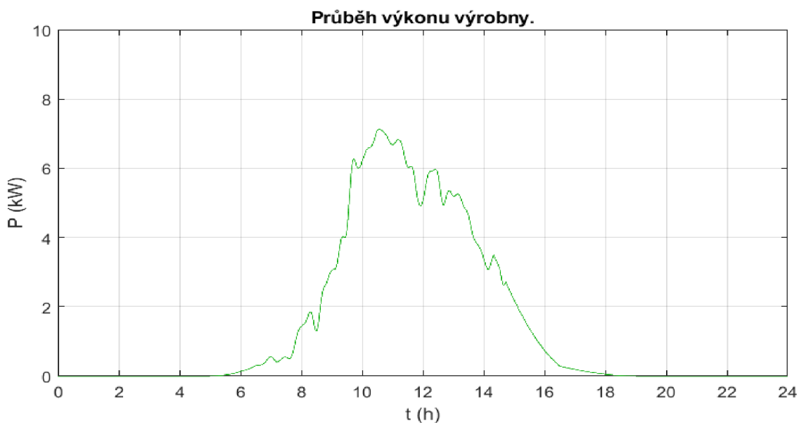
Obrázek 22: Příklad průběhu výkonu výroby, P_i = 10 \text{ kWp}
