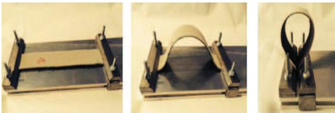
Obrázek 19. Tvorba smyčky: a) počáteční poloha, b) neúplná smyčka, c) konečný tvar
