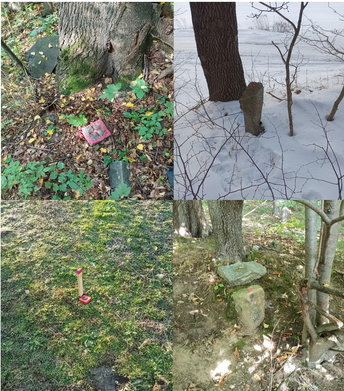
Obrázek 18 – Způsoby stabilizace ObPÚ
