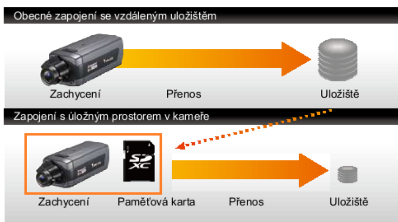
Obrázek 11: Princip přepisu dat z paměťové karty do záznamového zařízení [15]
