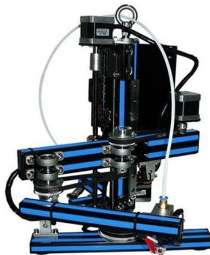
Obr. 8 3D tiskárna typu Scara [19].
