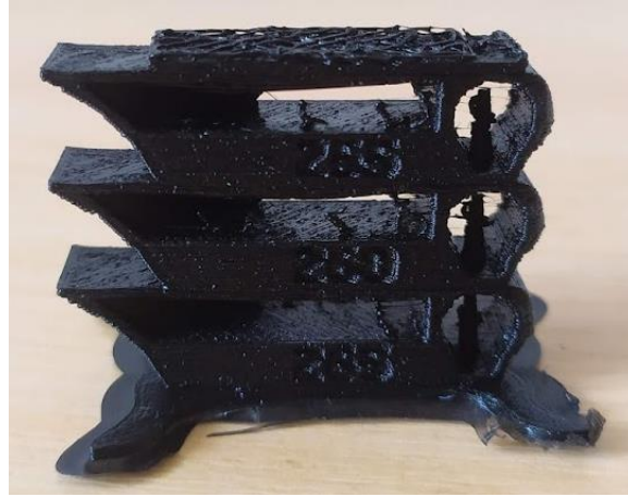
Obr. 59 Teplotní věž ASA.
