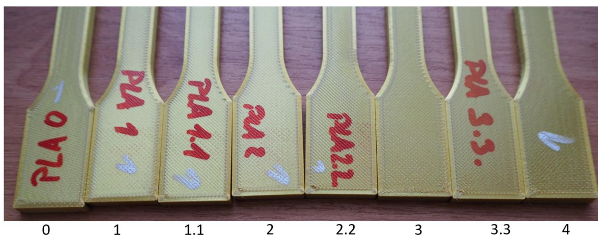
Obr. 58 Porovnání kvality tisku PLA na vzorcích pro tahovou zkoušku.
