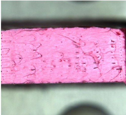
Obr. 82 Lom vysušeného ABS ve stavu 0.
