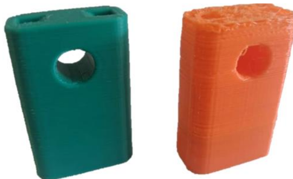
Obr. 2 Porovnání dílců vyrobených ze suchého filamentu (vlevo) a vlhkého (vpravo) [6].
