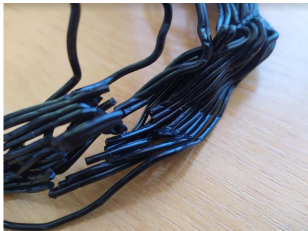
Obr. 38 Ukázka zapečeného filamentu.
