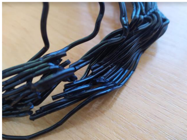
Obr. 38 Ukázka zapečeného filamentu.
