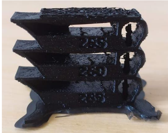
Obr. 59 Teplotní věž ASA.
