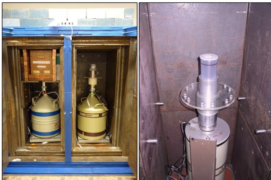
Obr. č. 22 a 23: HPGe detektory v ocelovém stínění a detektor se vzorkem v geometrii „masíovka na detektoru“ Zdroj: (SÚRO Praha – Nusle, Hradec Králové)
