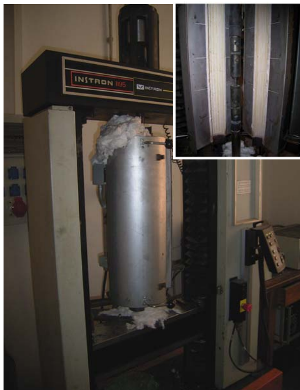
Obr. 26 – Stroj Instron model 1195 pro tahové zkoušky za vysokých teplot
