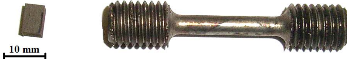
Obr. 27 – Zkušební vzorky pro zkoušku tlakem (vlevo) a pro zkoušku tahem (vpravo)
