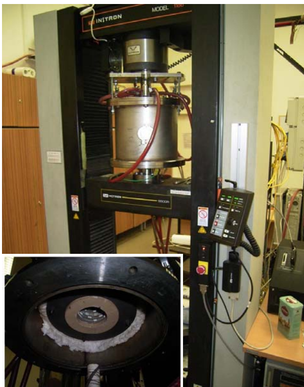
Obr. 25 – Stroj Instron model 1186 pro tlakové zkoušky za vysokých teplot
