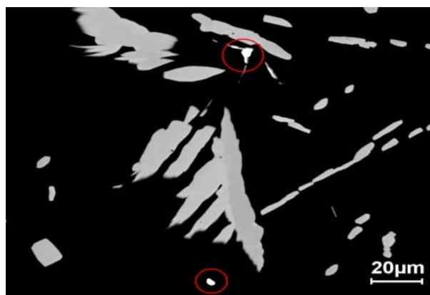
Obr. 66 – Detail precipitátů v materiálu 2130 as cast + 1200/24 (zvýrazněny červenými kroužky částice NbC), černá – matrice, šedá – Lavesova fáze HV 15kV, BSE detektor
