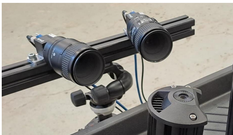
Obrázek 4 Konfigurace kamer při 3D DIC.
