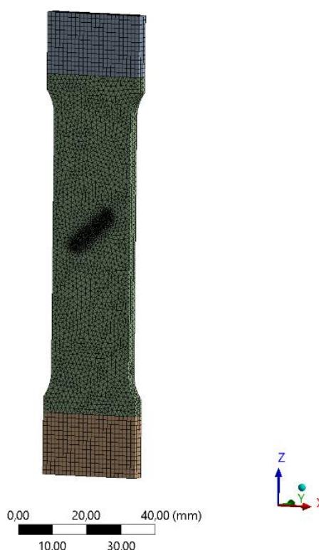
Obrázek 44 Použitá síť konečných prvků.
