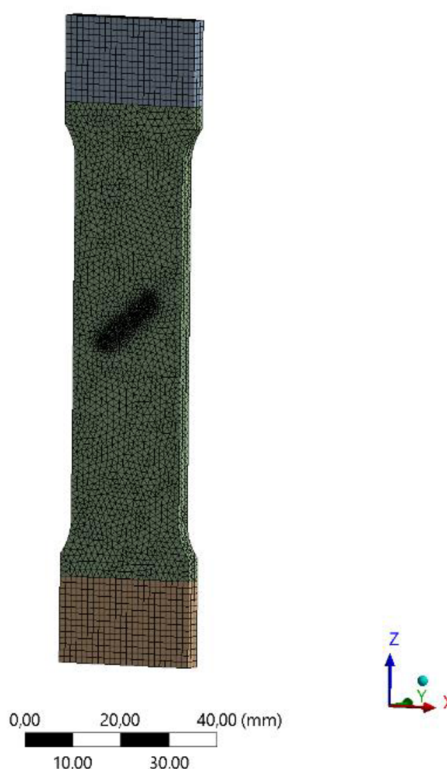
Obrázek 44 Použitá síť konečných prvků.
