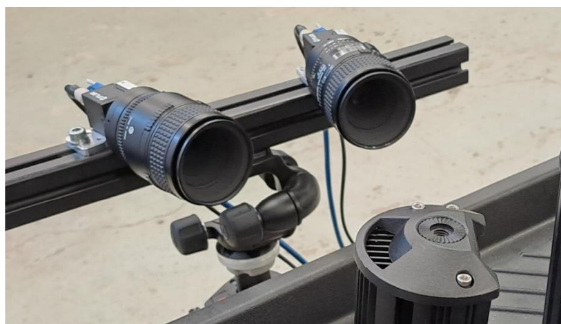
Obrázek 4 Konfigurace kamer při 3D DIC.
