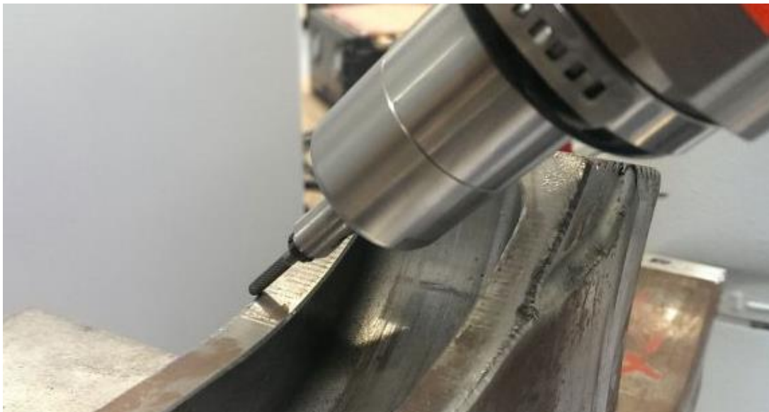
Obr. 4) Stacionárně upnutý díl obráběný koncovým efektořem na robotickém rameni [14]
