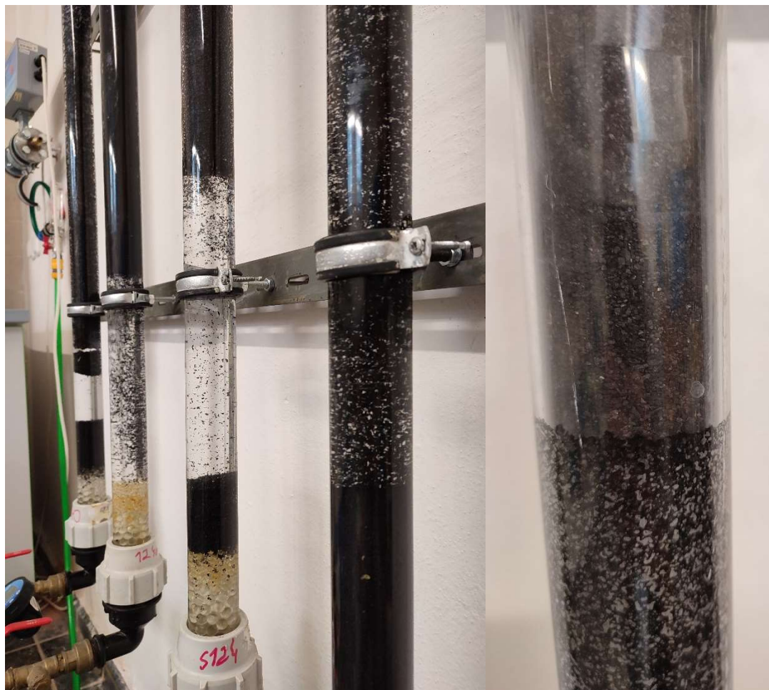
Obr. 24 Filtrační kolony během namáčení
