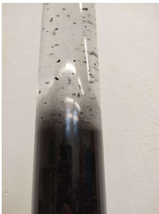
Obr. 25 Filtrační kolona při procesu praní
