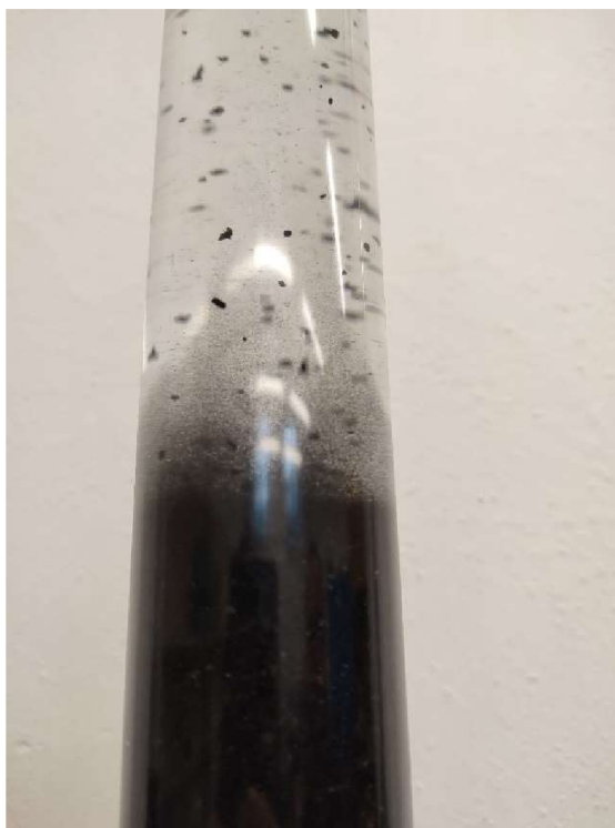
Obr. 25 Filtrační kolona při procesu praní
