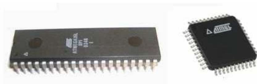
Obrázek 3: Pouzdro DIP40 (vlevo) a TQFP44 (vpravo) [http://cz.farnell.com]
