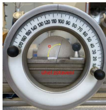
Obrázek 32 - Měření úhlu zotavení na kruhové stupnici
