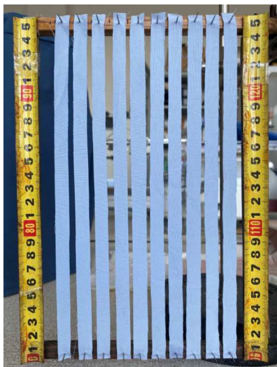
Obrázek 42 - Schéma zařízení pro zkoušku nasákavosti metodou vzlínání – příprava vzorků.
