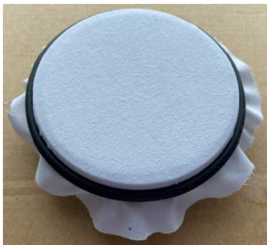
Obrázek 54 - Vzorek A – povrch textilie po 7000 otáčkách
