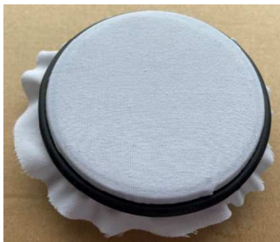
Obrázek 53 - vzorek B – povrch textilie po 7000 otáčkách
