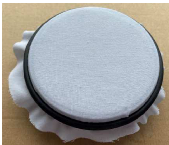
Obrázek 53 - vzorek B – povrch textilie po 7000 otáčkách
