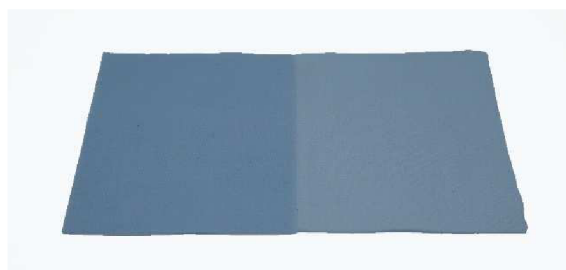
Obrázek 60 - Vzorek A po 20 cyklech prání.
