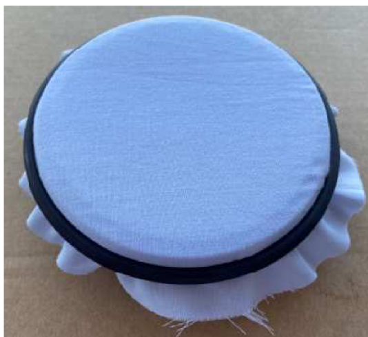
Obrázek 55 - vzorek C – povrch textilie po 7000 otáčkách
