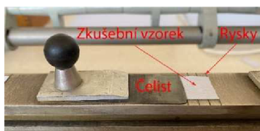
Obrázek 34 - Upnutý vzorek do čelistí
