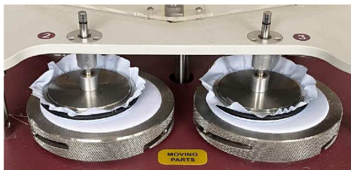
Obrázek 48 - Oděr textilií na přístroji Martindale.
