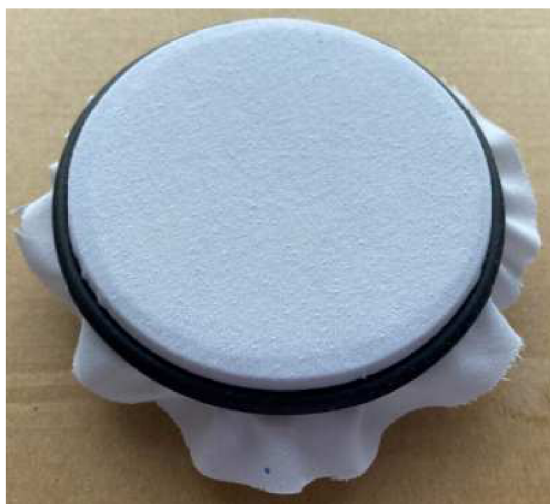
Obrázek 54 - Vzorek A – povrch textilie po 7000 otáčkách
