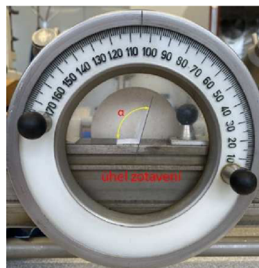
Obrázek 32 - Měření úhlu zotavení na kruhové stupnici
